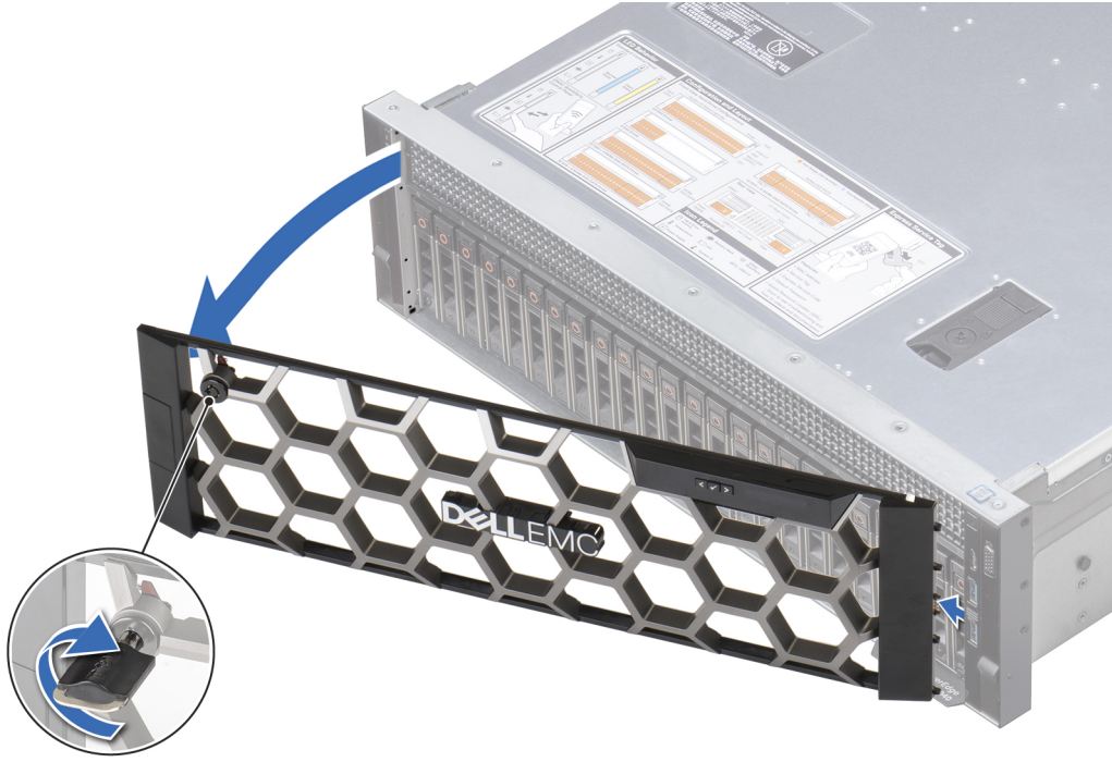
Rakam 20. İsteğe bağlı ön çerçeveyi LCD paneliyle çıkarma
