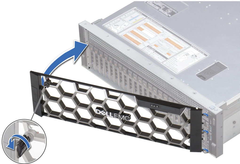
Figure 21. Installation du panneau avant (en option) avec écran LCD
