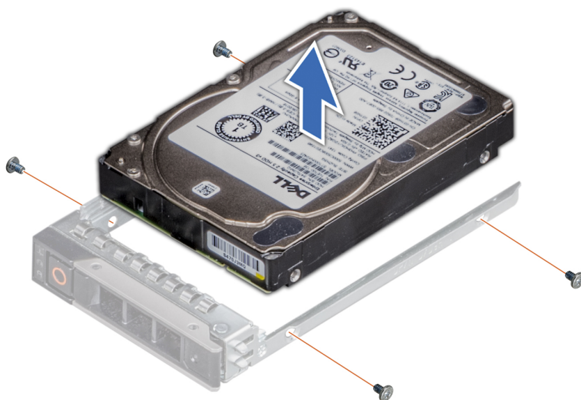
Figure 42. Retrait d'un disque installé dans un support
