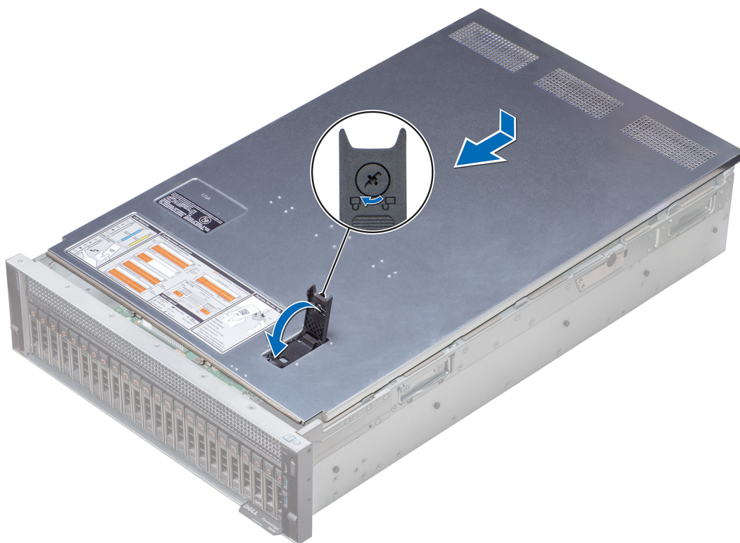
Figure 23. Installation du capot du système
