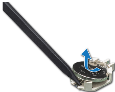
Figure 100. Retrait de la pile du système
