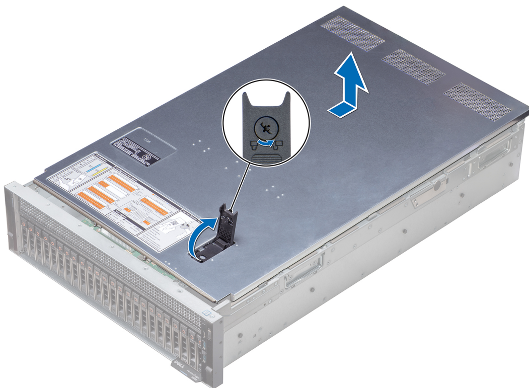
Figure 22. Retrait du capot du système
