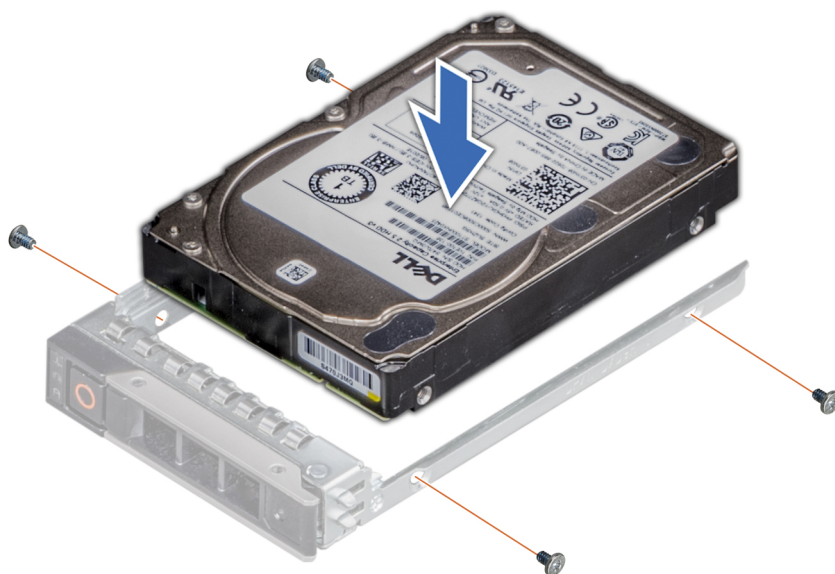
Figure 43. Installation d'un disque dans son support
