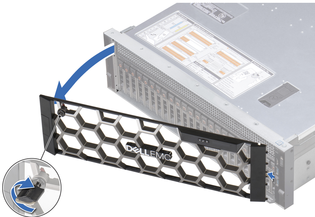
Figure 20. Retrait du panneau avant (en option) avec l'écran LCD
