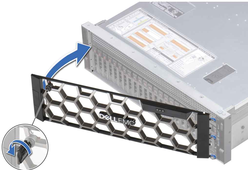
Ilustración 21. Instalación del bisel frontal opcional con el panel de LCD
