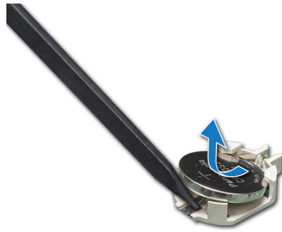
Ilustración 100. Extracción de la batería del sistema
