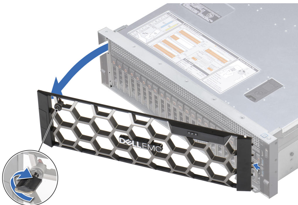
Ilustración 20. Extracción del bisel frontal opcional con el panel de LCD
