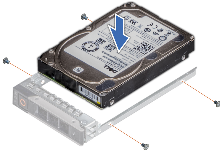
Ilustración 43. Instalación de una unidad en el portaunidades
