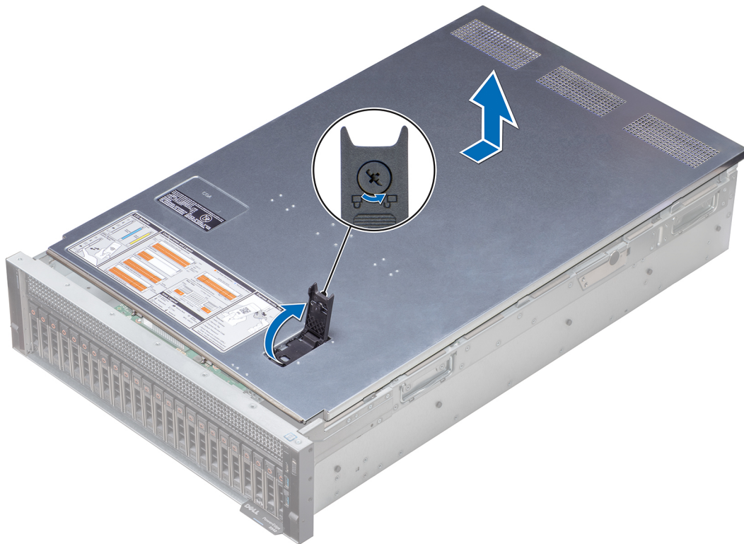
Ilustración 22. Extracción de la cubierta del sistema
