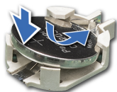
Abbildung 101. Installieren der Systembatterie
