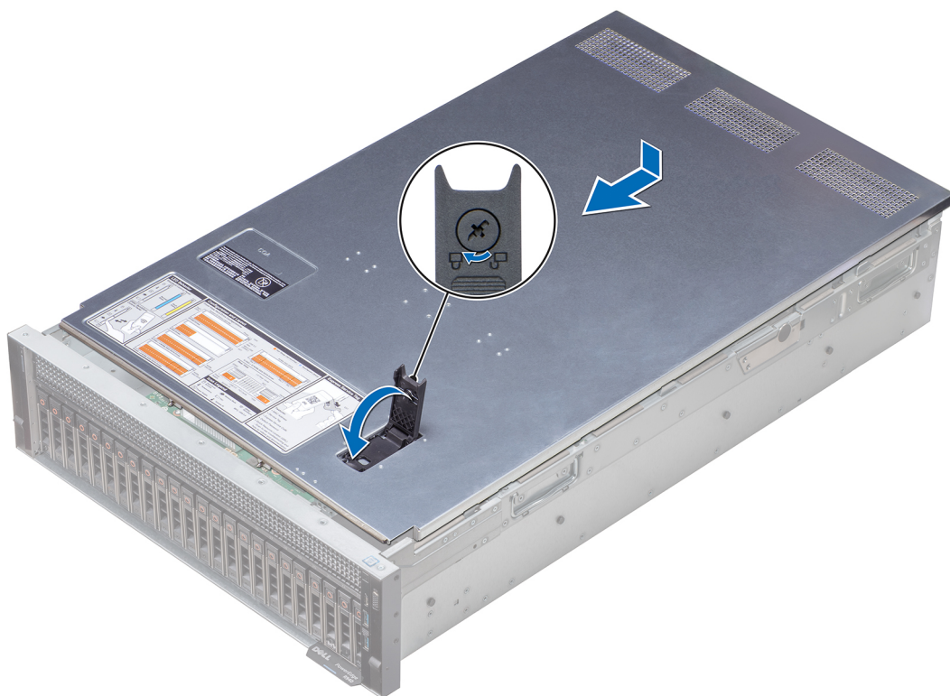
图 24: 安装系统护盖
