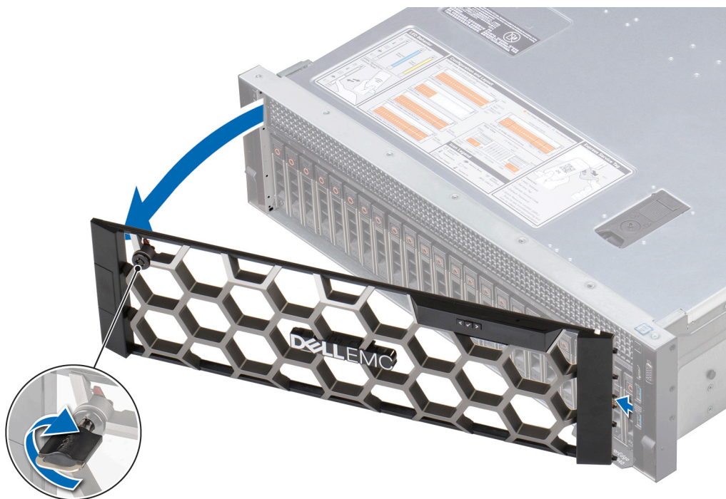
图 21: 卸下可选的前挡板与 LCD 面板
