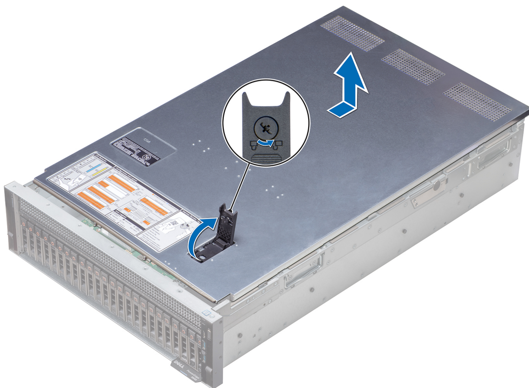
图 23: 卸下系统护盖
