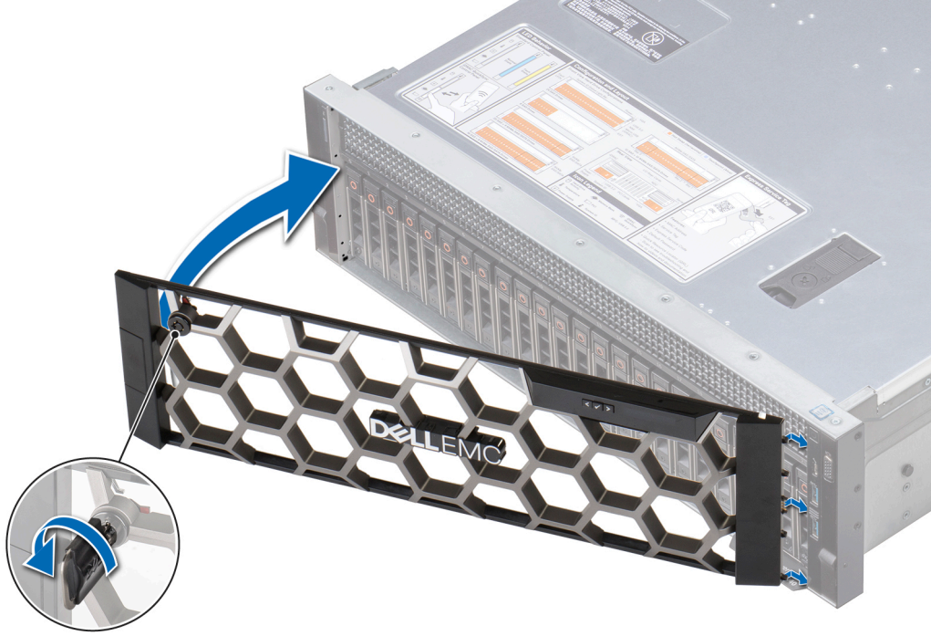
Rakam 22. LCD panelli isteğe bağlı ön çerçeveyi takma
