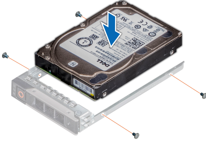
Rakam 44. Sürücü taşıyıcısına sürücü takma
