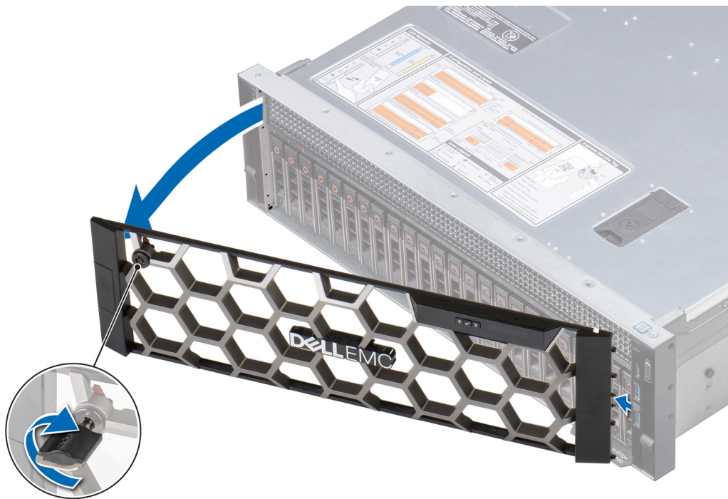
図 21. LCD パネルを搭載したオプションの前面ベゼルの取り外し
