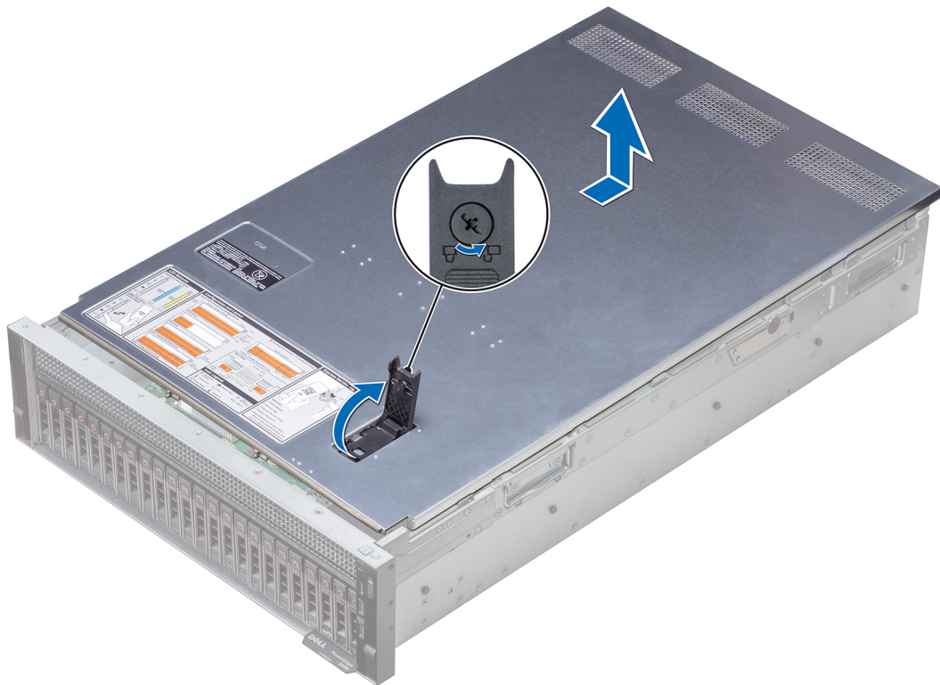
図 23. システムカバーの取り外し
