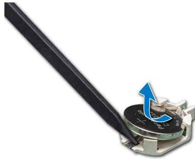
Ilustración 101. Extracción de la batería del sistema
