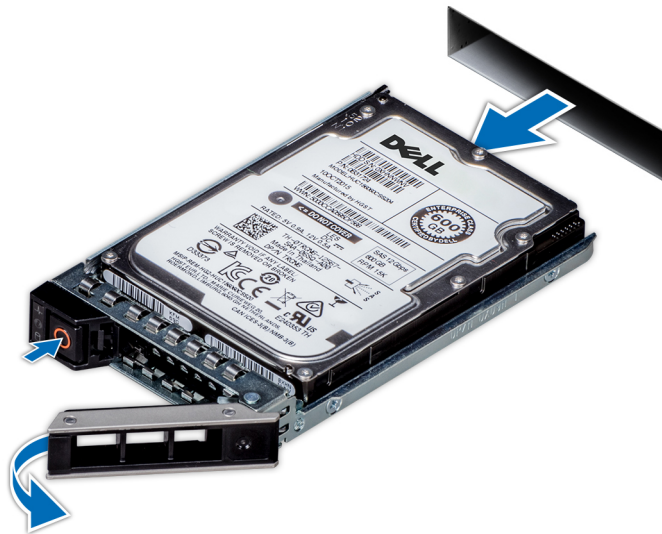
Abbildung 41. Entfernen eines Festplattenträgers
