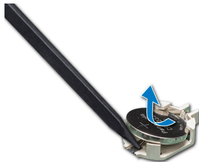
Abbildung 101. Entfernen der Systembatterie
