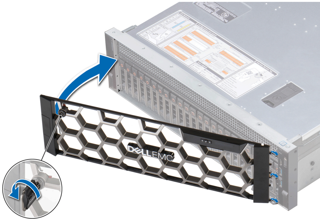
Abbildung 22. Installieren der optionalen Frontverkleidung mit LCD-Display
