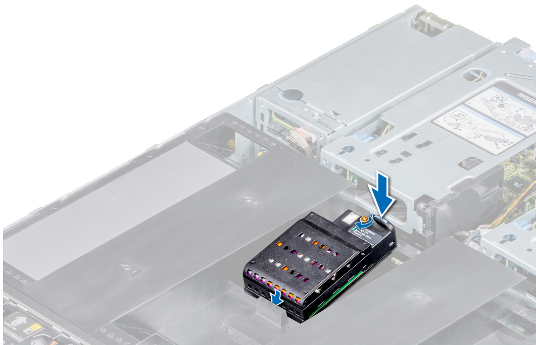
图 33: 将 NVDIMM-N 电池安装到非 GPU 导流罩中
