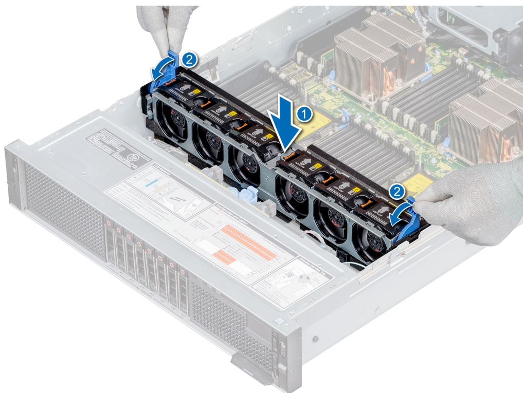
图 28: 安装冷却风扇部件
