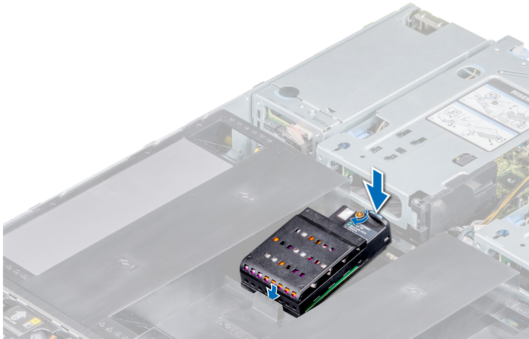
그림 33. 비 GPU 공기 커버에 NVDIMM-N 배터리 설치
