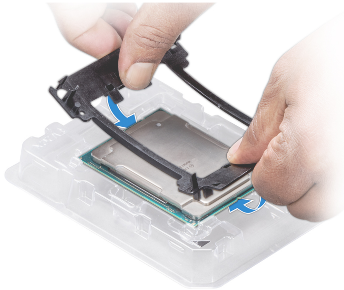
Abbildung 70. Installieren der Prozessor-Halterung
