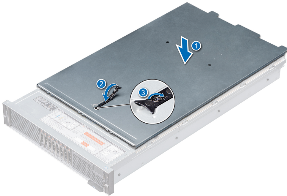
Abbildung 20. Installieren der Systemabdeckung
