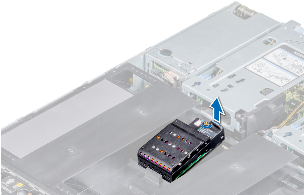
Abbildung 31. Entfernen der NVDIMM-N-Batterie aus dem Nicht-GPU-Kühlgehäuse
