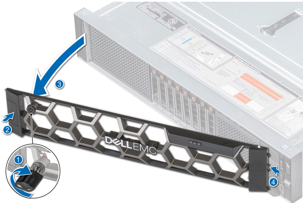
Abbildung 17. Entfernen der optionalen Frontverkleidung (Blende)
