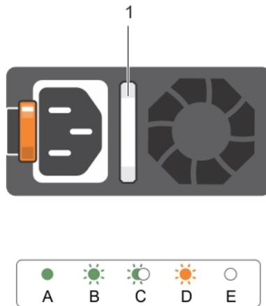
図 8. AC PSU ステータスインジケータ
