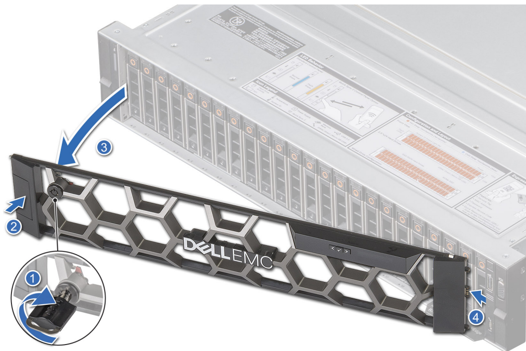
Ilustración 18. Extracción del bisel frontal
