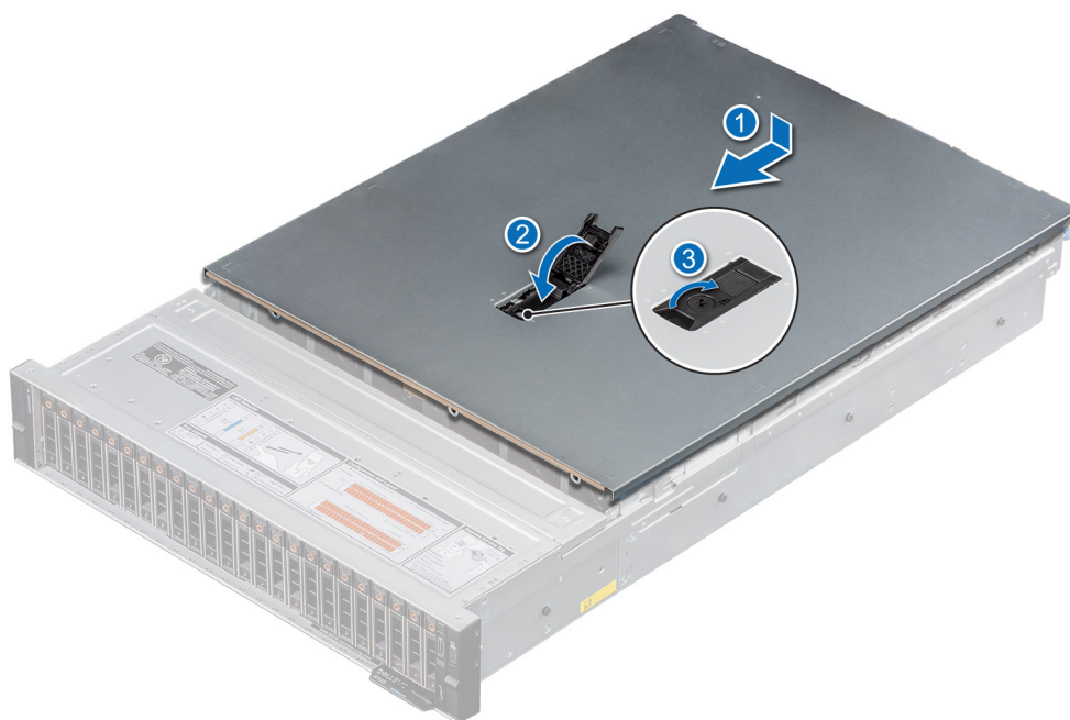
Ilustración 21. Instalación de la cubierta del sistema
