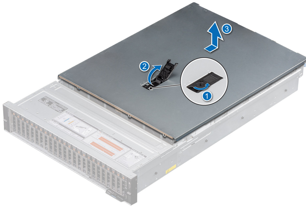
Ilustración 20. Extracción de la cubierta del sistema
