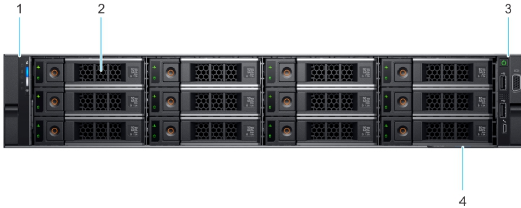
Rakam 2. 12 x 3,5 inç sürücü sisteminin önden görünümü
