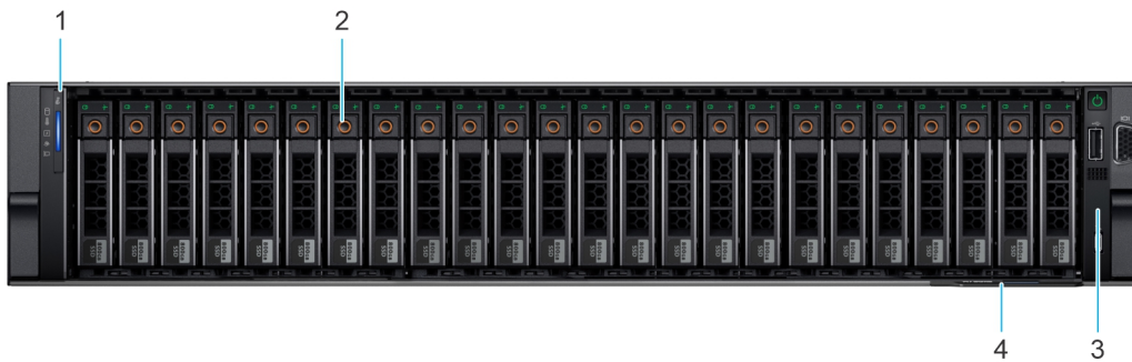
Rakam 1. 16 x 2,5 inç SAS/SATA + 8 x 2,5 inç NVMe sürücülü sistemin önden görünümü
