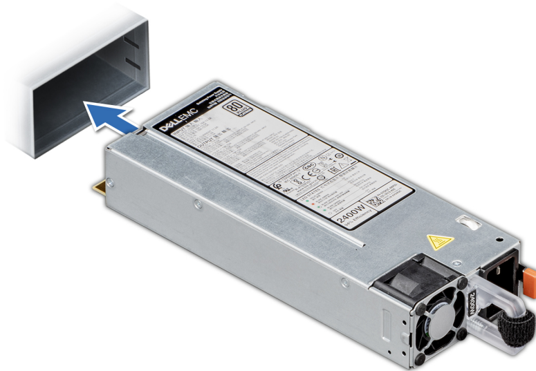
Figure 166. Installation d'un bloc d'alimentation
