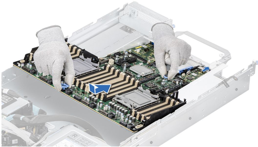
Figure 169. Installation de la carte système
