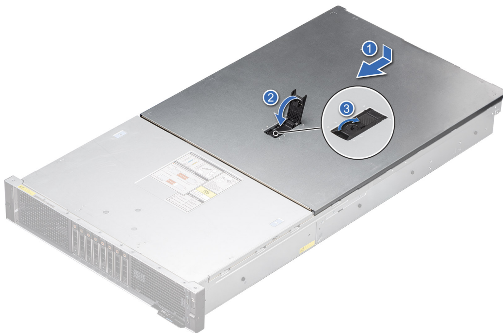
Ilustración 24. Instalación de la cubierta del sistema
