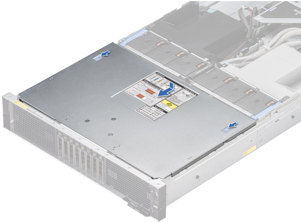
Ilustración 26. Instalación de la cubierta del backplane de la unidad
