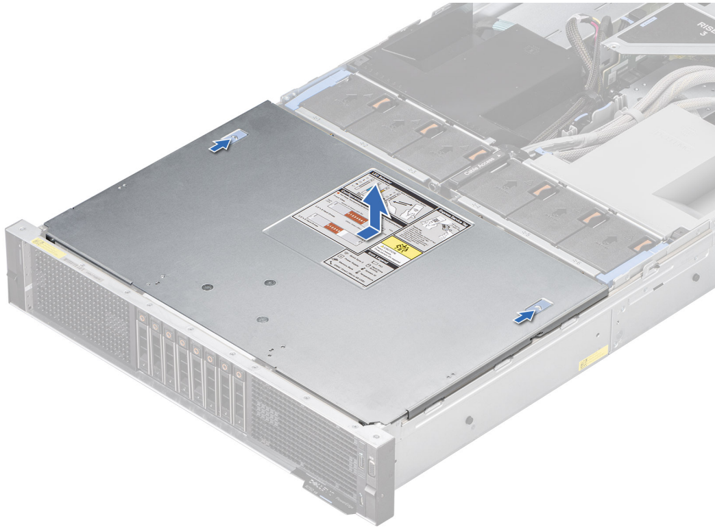
Ilustración 25. Extracción de la cubierta del backplane de la unidad
