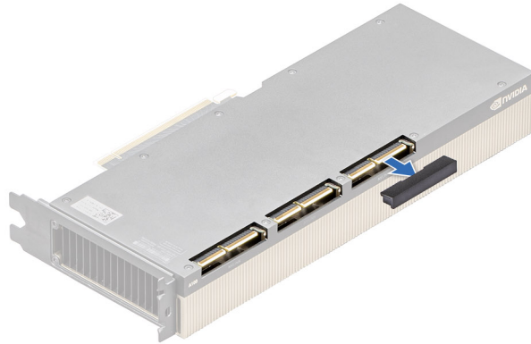
Abbildung 118. Entfernen der NVLink-Abdeckung
