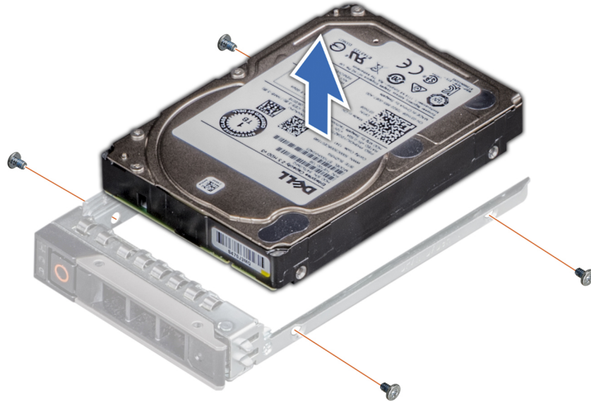
Abbildung 42. Laufwerk aus Laufwerkträger entfernen
