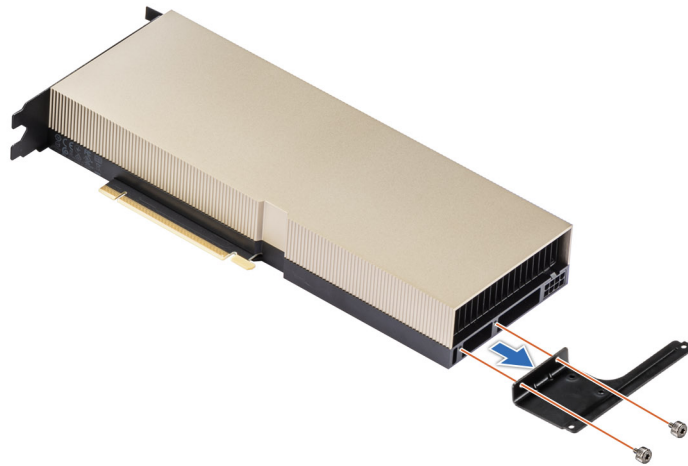
Abbildung 102. Entfernen der Standardhalterung mit zwei Schrauben
