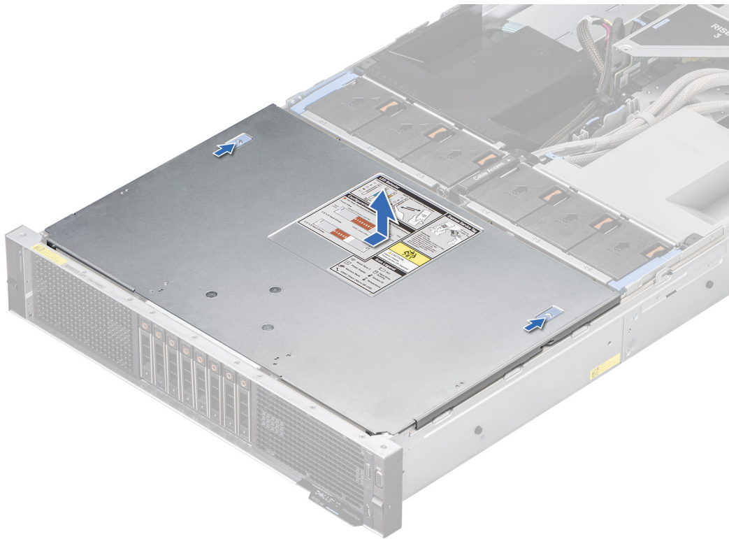
Abbildung 25. Entfernen der Laufwerk-Rückwandplattenabdeckung
