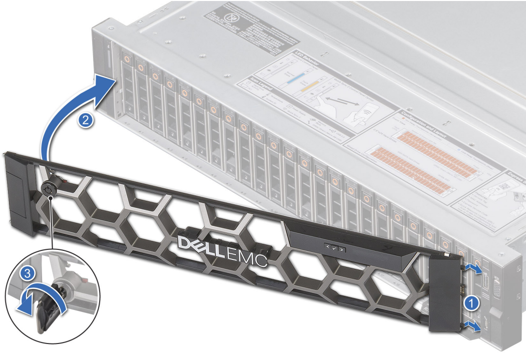
Rakam 26. LCD panelli ön çerçeveyi takma
