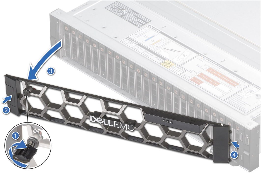
Rakam 25. LCD paneli ön çerçeveyi çıkarma
