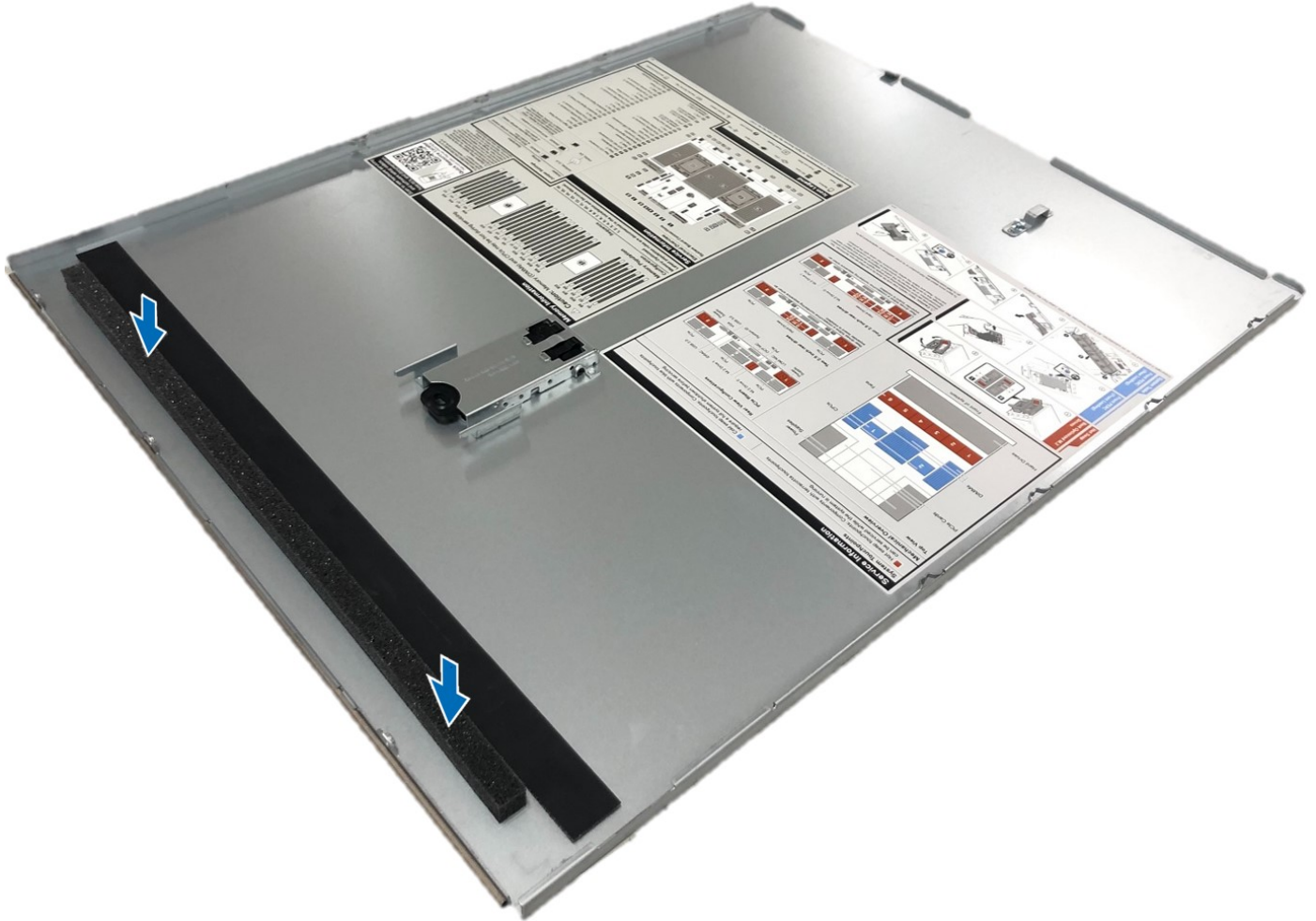
Rakam 232. Mylar köpüğü sistem kapağına takma
