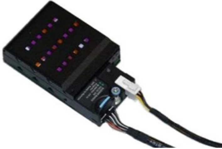
Rakam 238. NVDIMM güç ve sinyal kablolarını NVDIMM piline bağlayın
