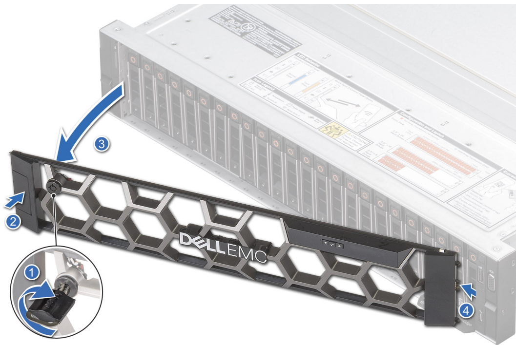
Figure 25. Retrait du panneau avant avec l'écran LCD
