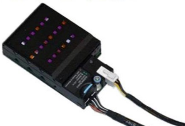
Figure 238. Branchement des câbles d'alimentation et de transmission à la batterie NVDIMM
