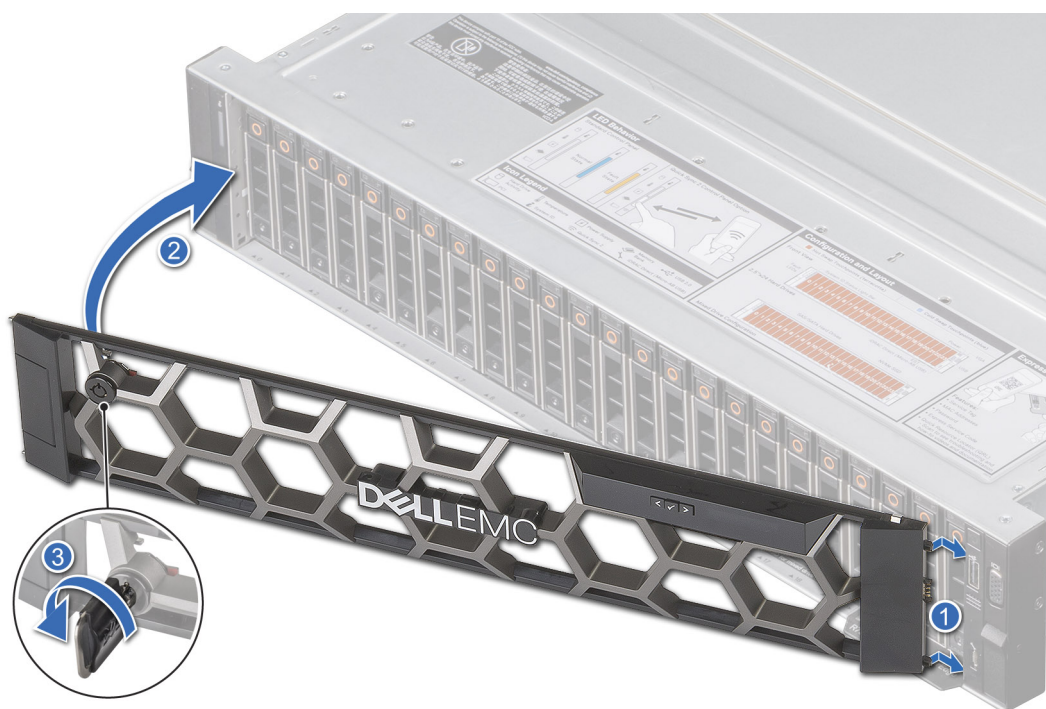
Figure 26. Installation du panneau avant avec l'écran LCD
