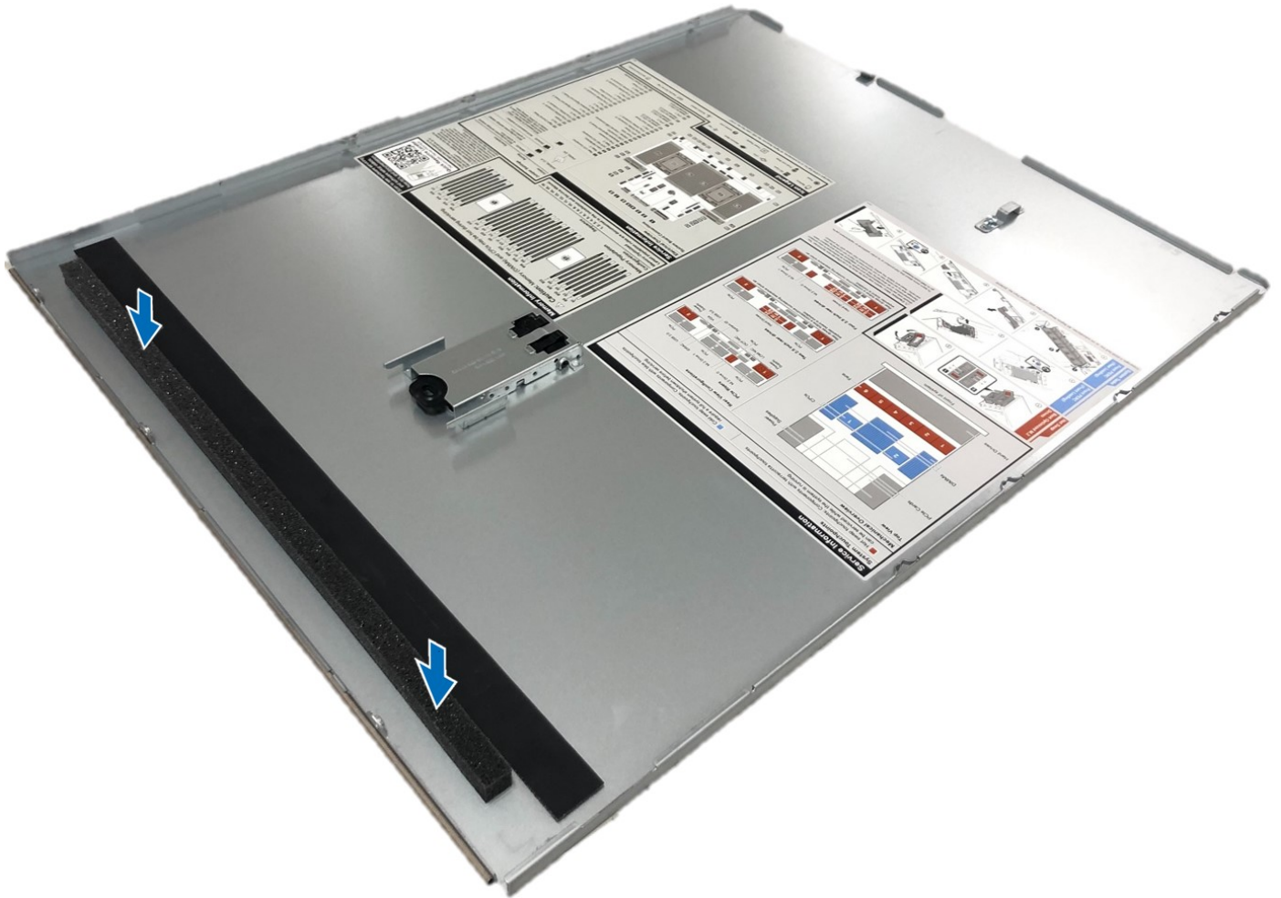
Figure 232. Installation de la mousse en Mylar sur le capot du système
