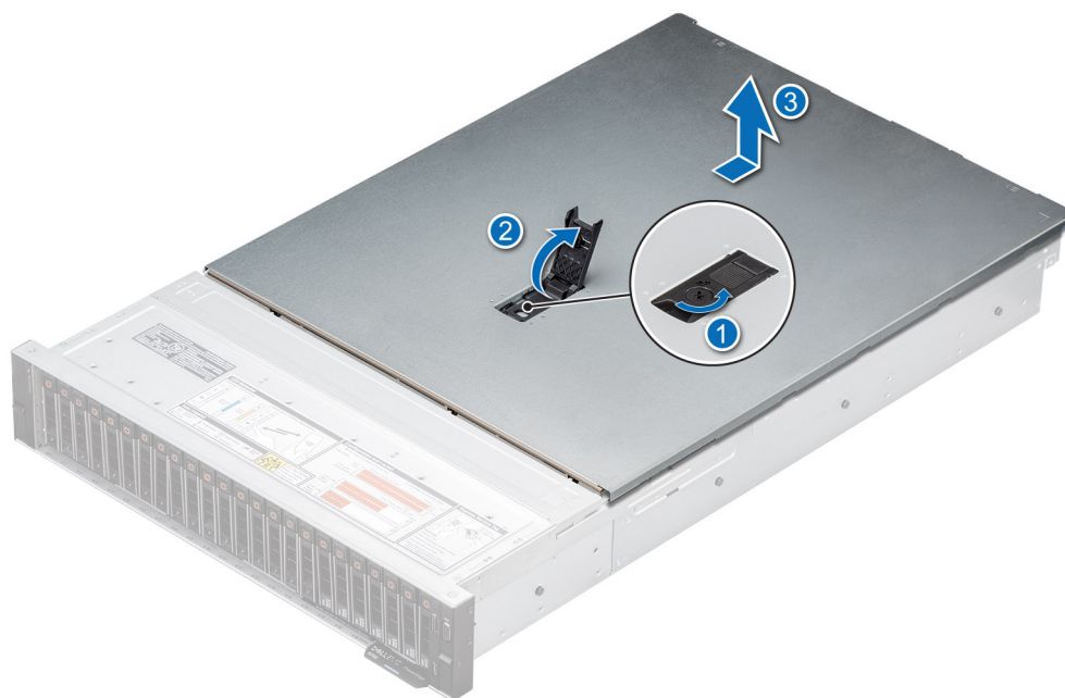
Figure 27. Retrait du capot du système
