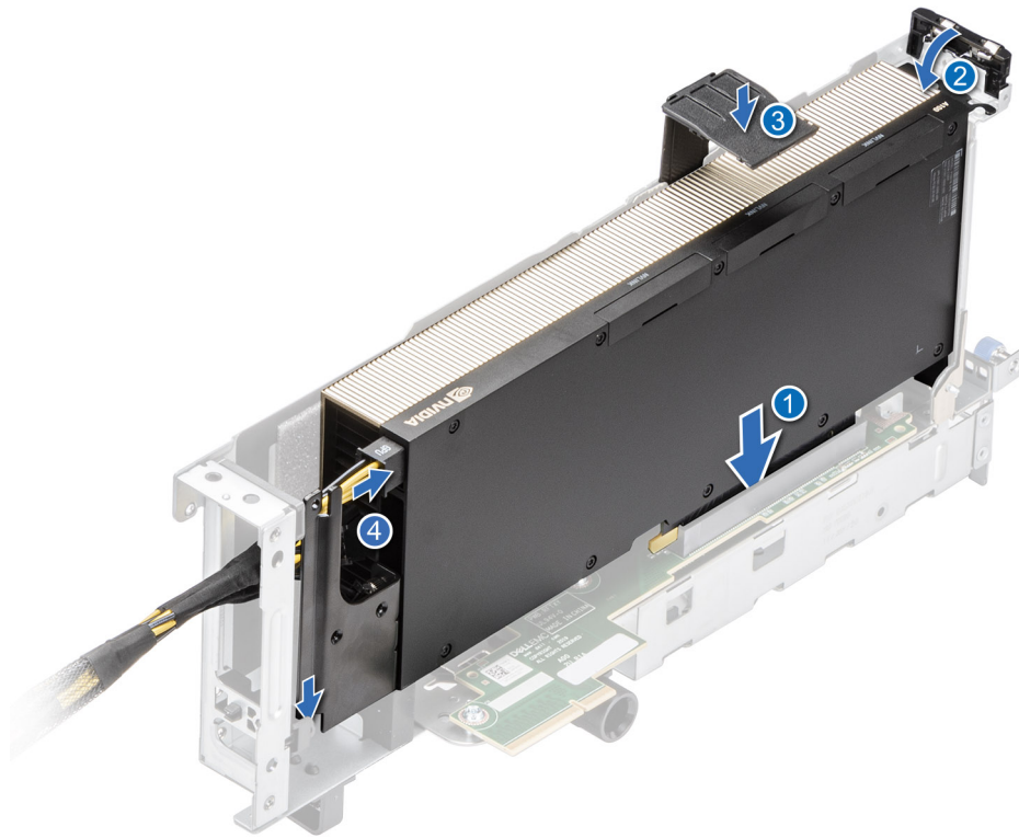
Figure 166. Installation du processeur graphique dans la carte de montage 1
