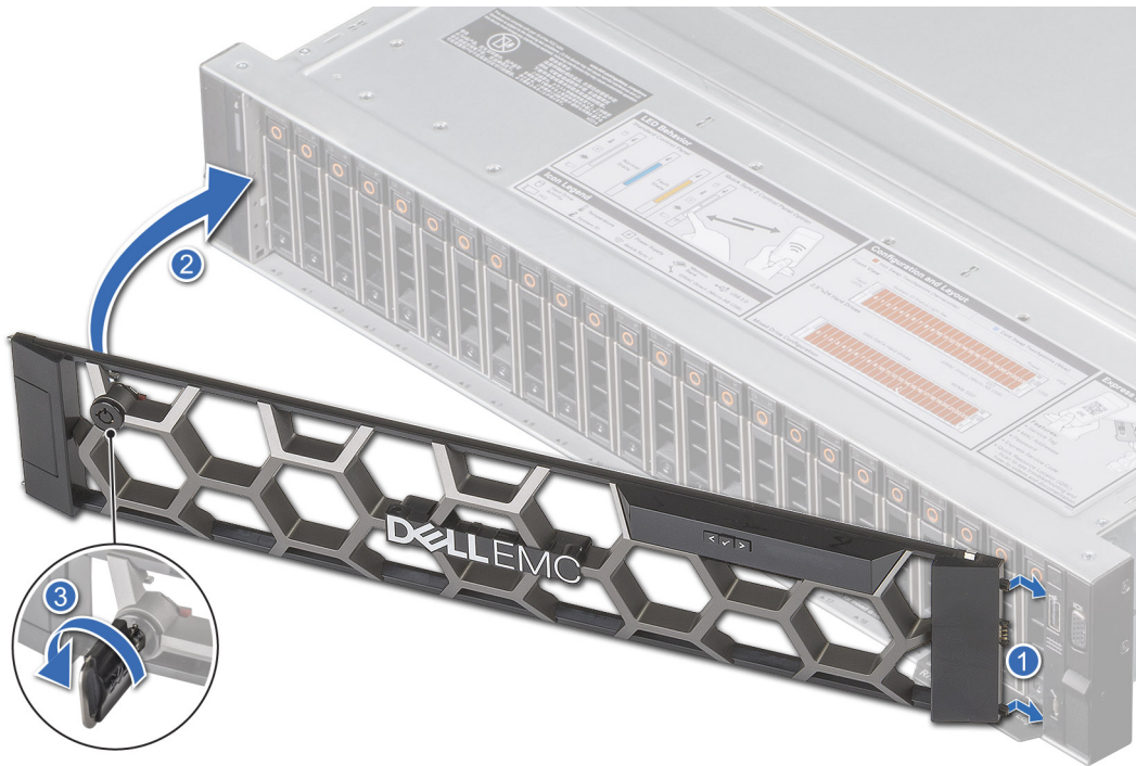
Ilustración 26. Instalación del bisel frontal con el panel LCD
