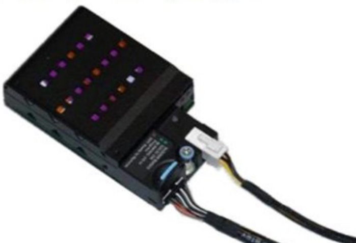
Ilustración 238. Conectar los cables de alimentación y de señal a la batería de NVDIMM
