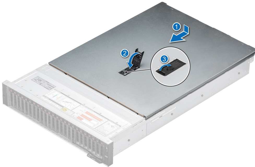
Ilustración 28. Instalación de la cubierta del sistema
