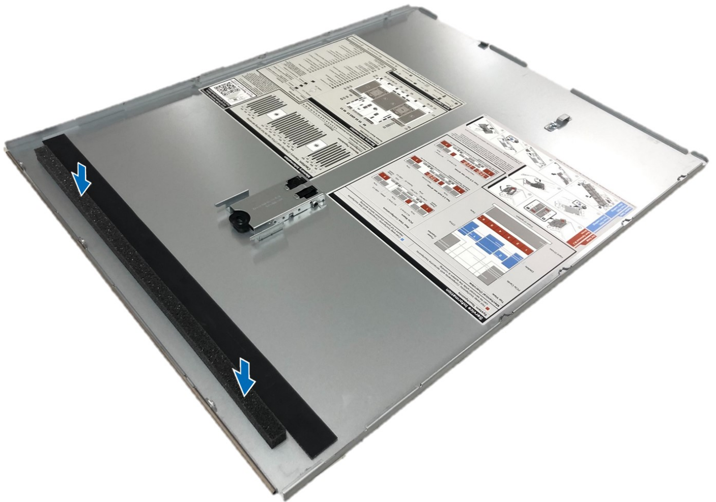
Ilustración 232. Instalación de espuma de mylar en la cubierta del sistema
