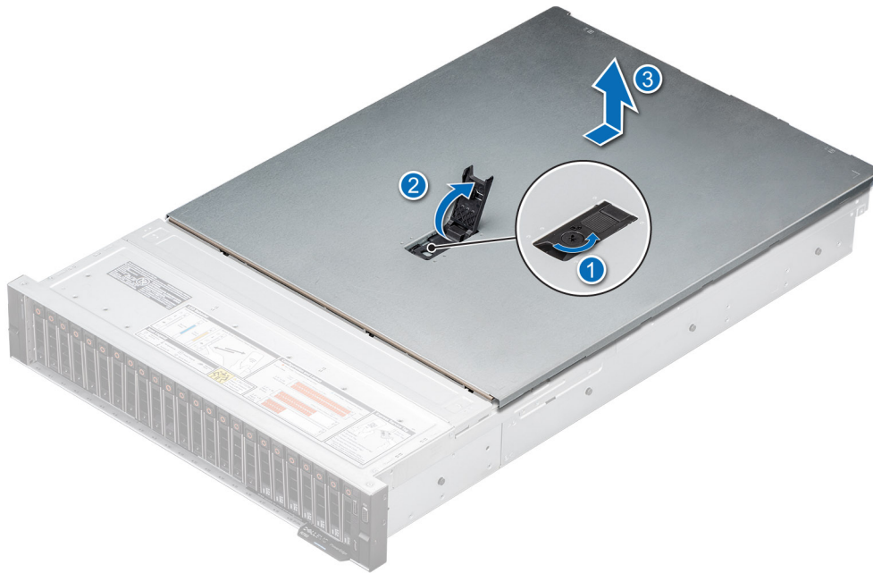
Ilustración 27. Extracción de la cubierta del sistema
