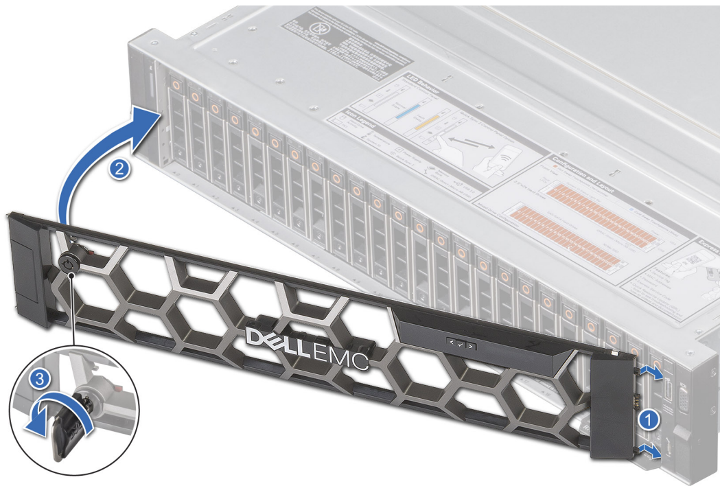
Abbildung 26. Installieren der Frontblende mit LCD-Display
