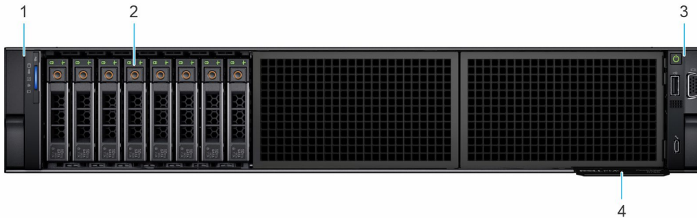
Abbildung 3. Vorderansicht eines Systems mit 8 x 2,5-Zoll-Laufwerken
