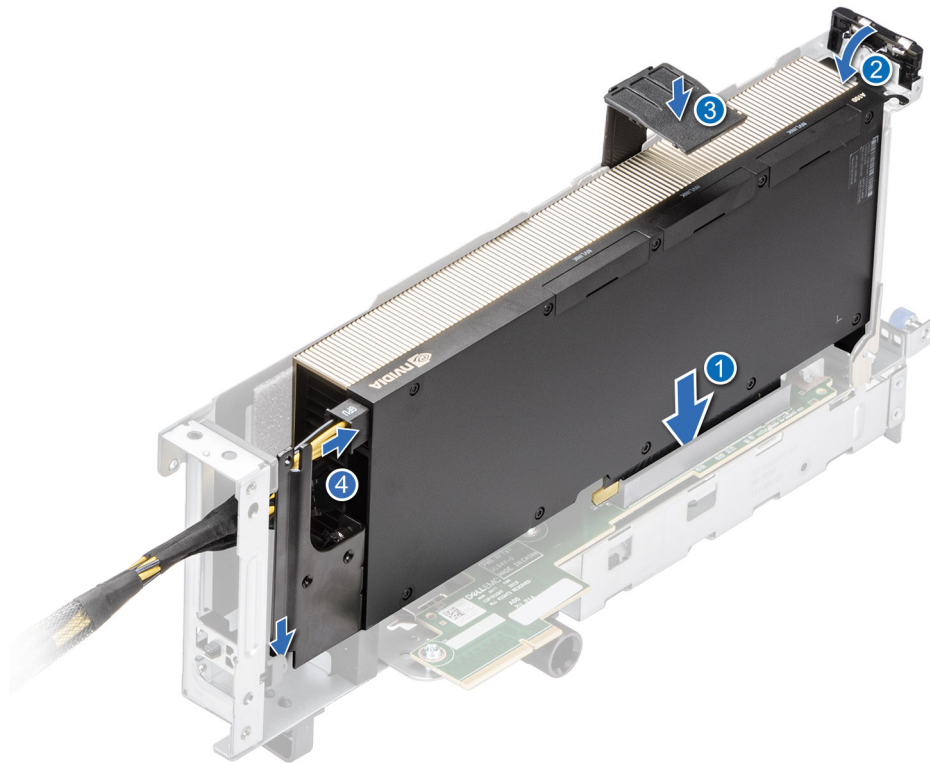
Abbildung 166. Installieren der GPU auf Riser 1
