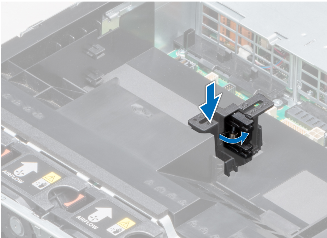
図 78. PCIe カードホルダラッチを開く
