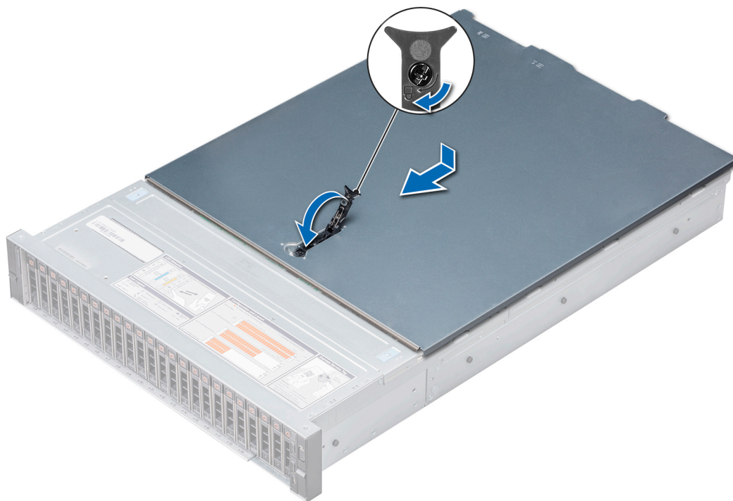
図 28. システムカバーの取り付け
