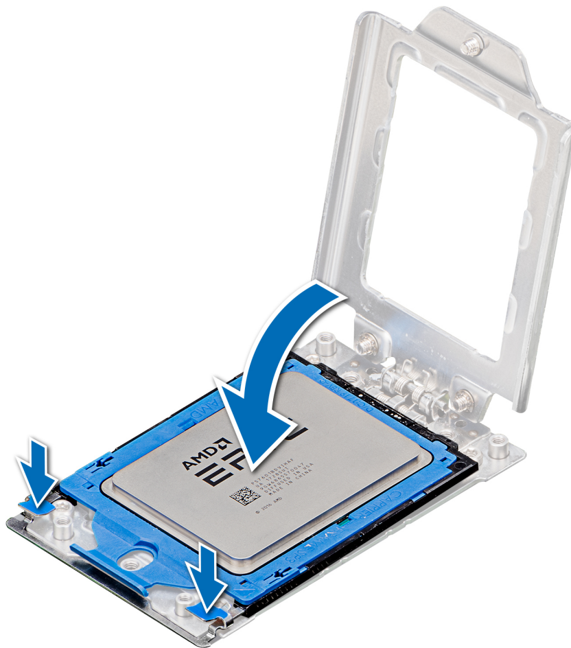
Figure 75. Fermeture du cadre de support du processeur
