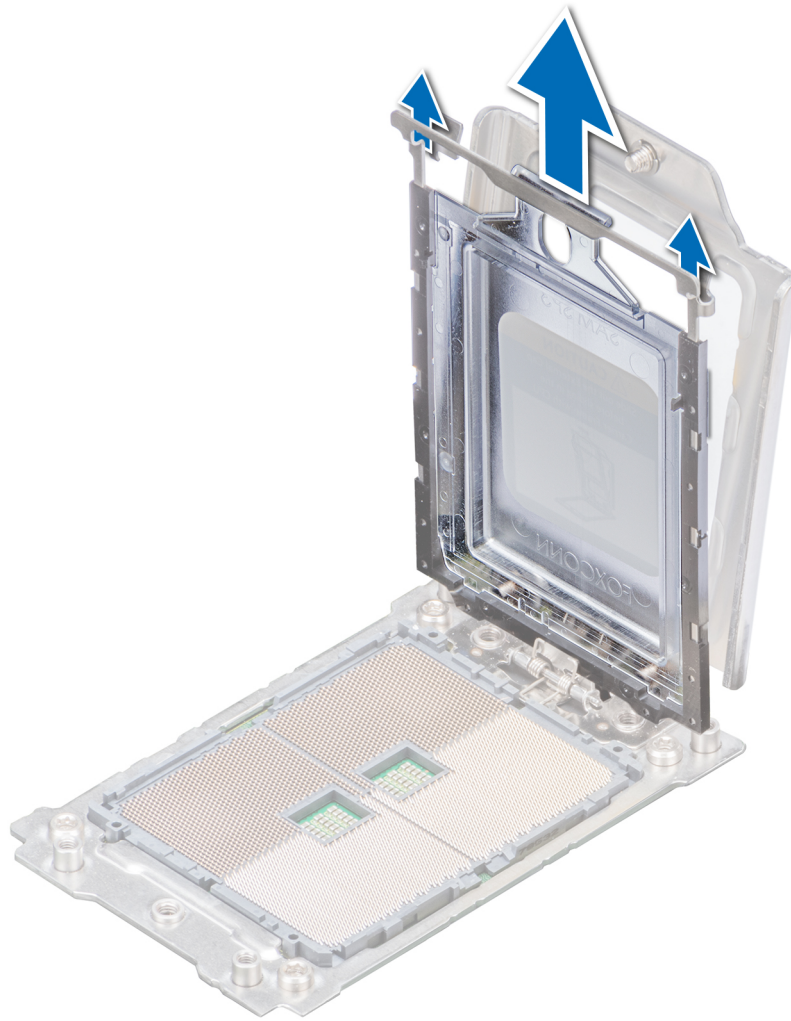
Figure 73. Retrait d'un cache de processeur
