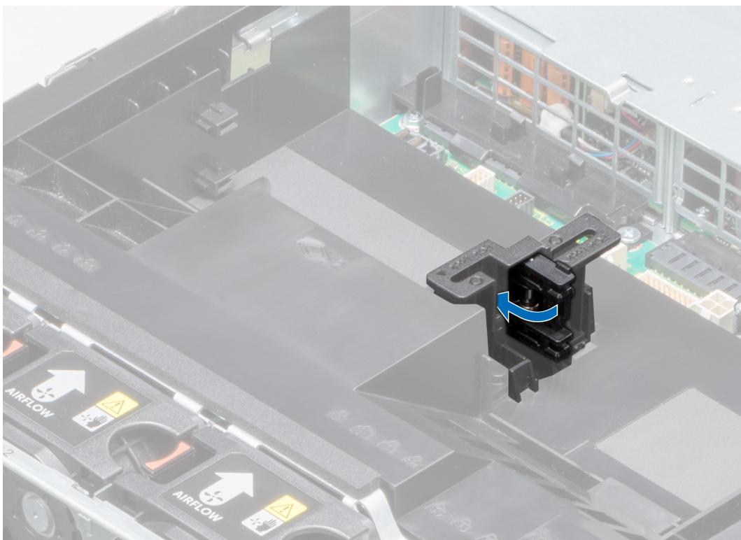
Figure 79. Fermeture du loquet du support de carte PCIe
