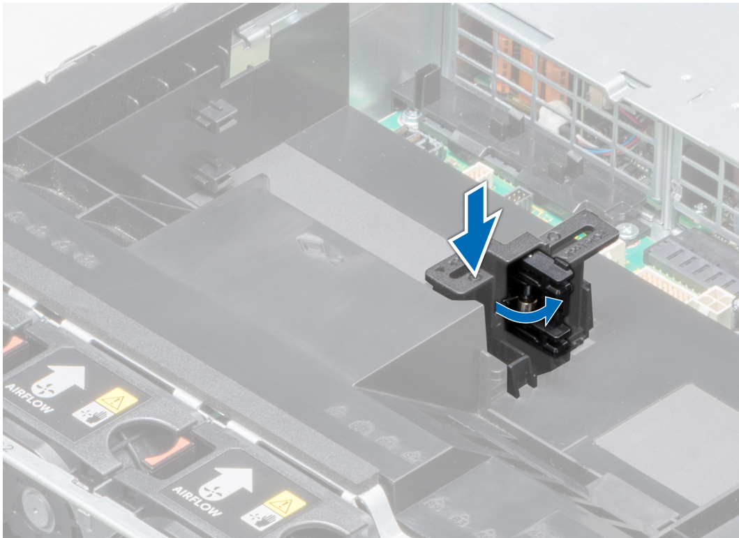
Figure 78. Ouverture du loquet du support de carte PCIe
