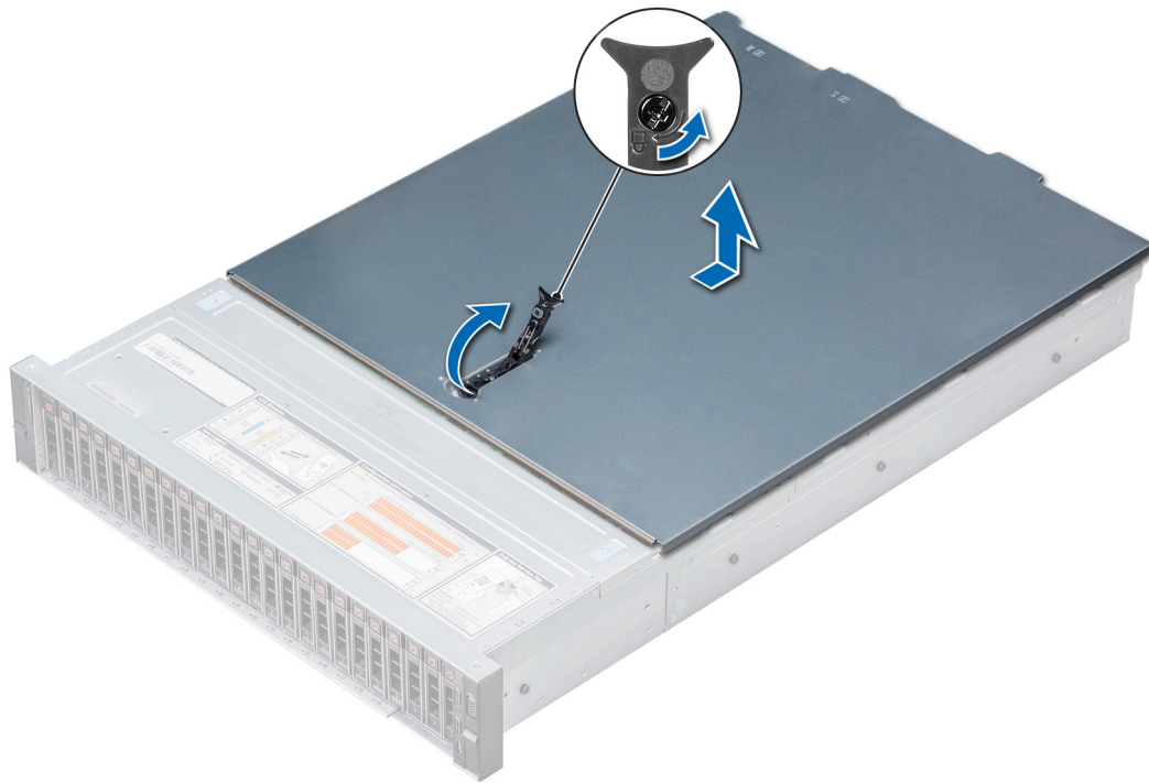
Figure 27. Retrait du capot du système
