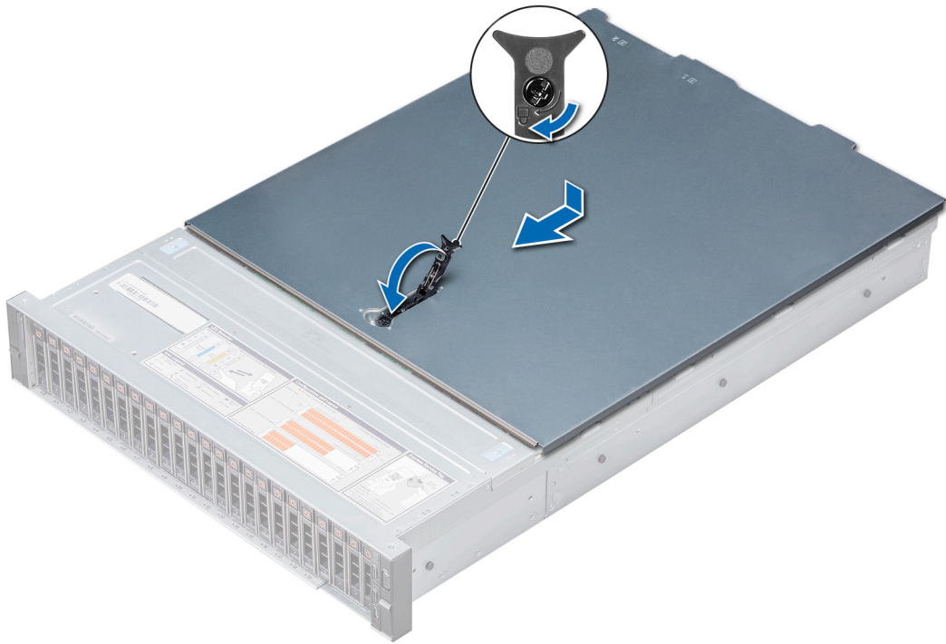
Figure 28. Installation du capot du système
