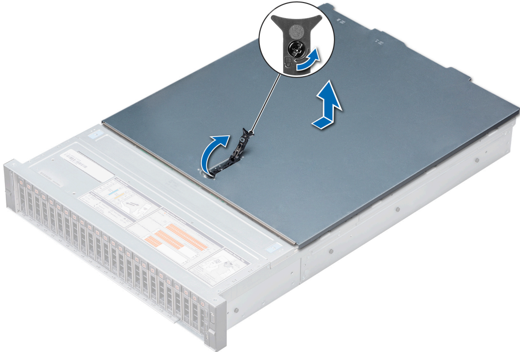
Ilustración 27. Extracción de la cubierta del sistema
