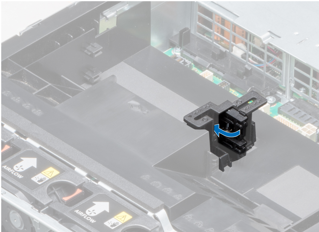
Ilustración 79. Cierre del pestillo del soporte de tarjeta PCIe
