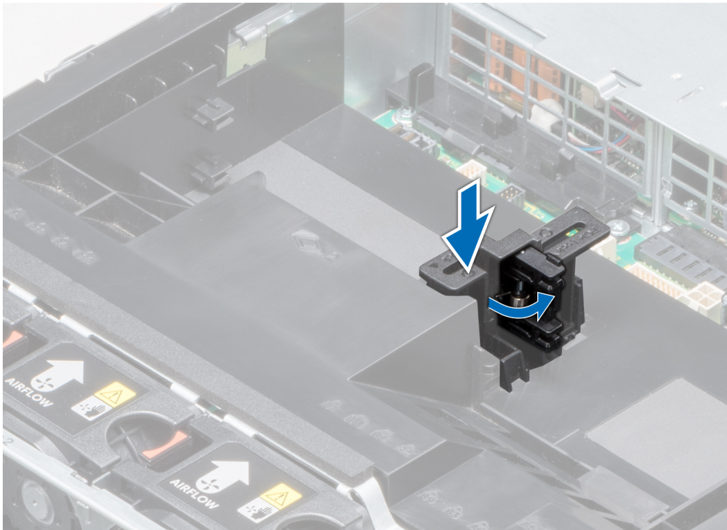
Ilustración 78. Cómo abrir el pestillo del soporte de tarjeta PCIe
