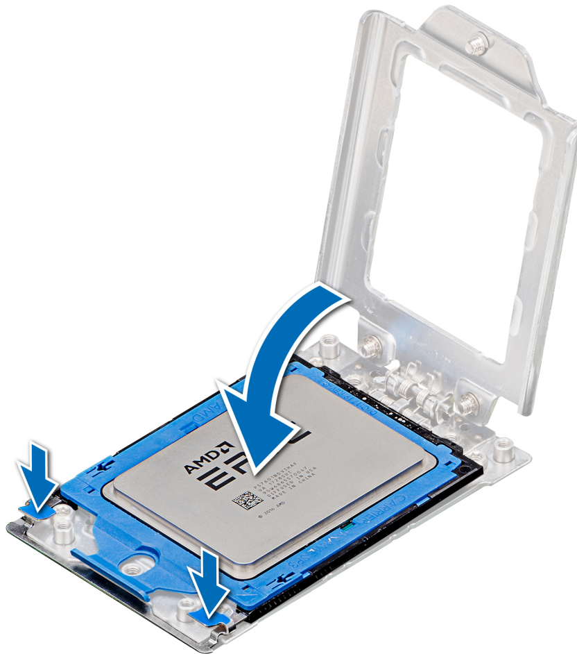
Abbildung 75. Schließen des Prozessorsockelrahmens
