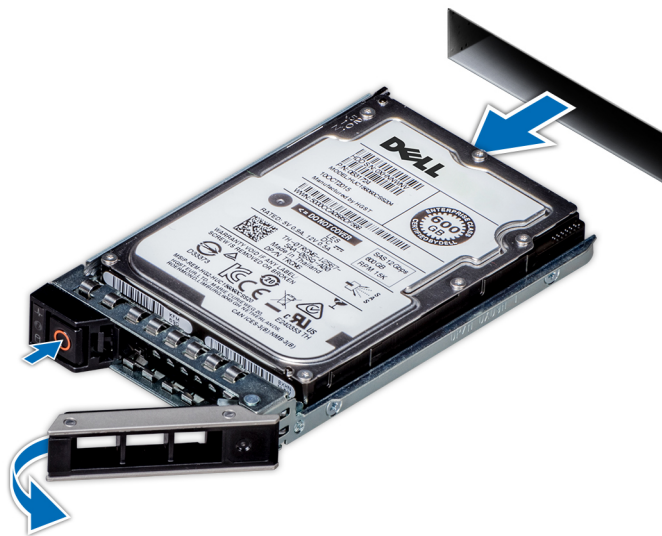
Abbildung 53. Entfernen eines Festplattenträgers
