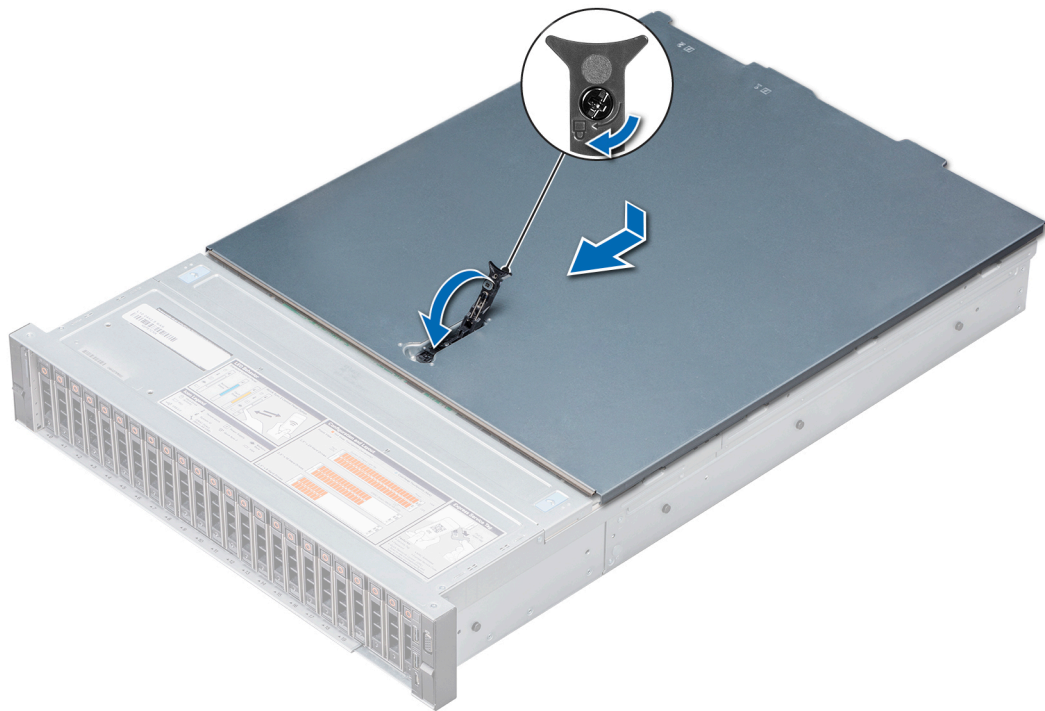
Abbildung 28. Installieren der Systemabdeckung
