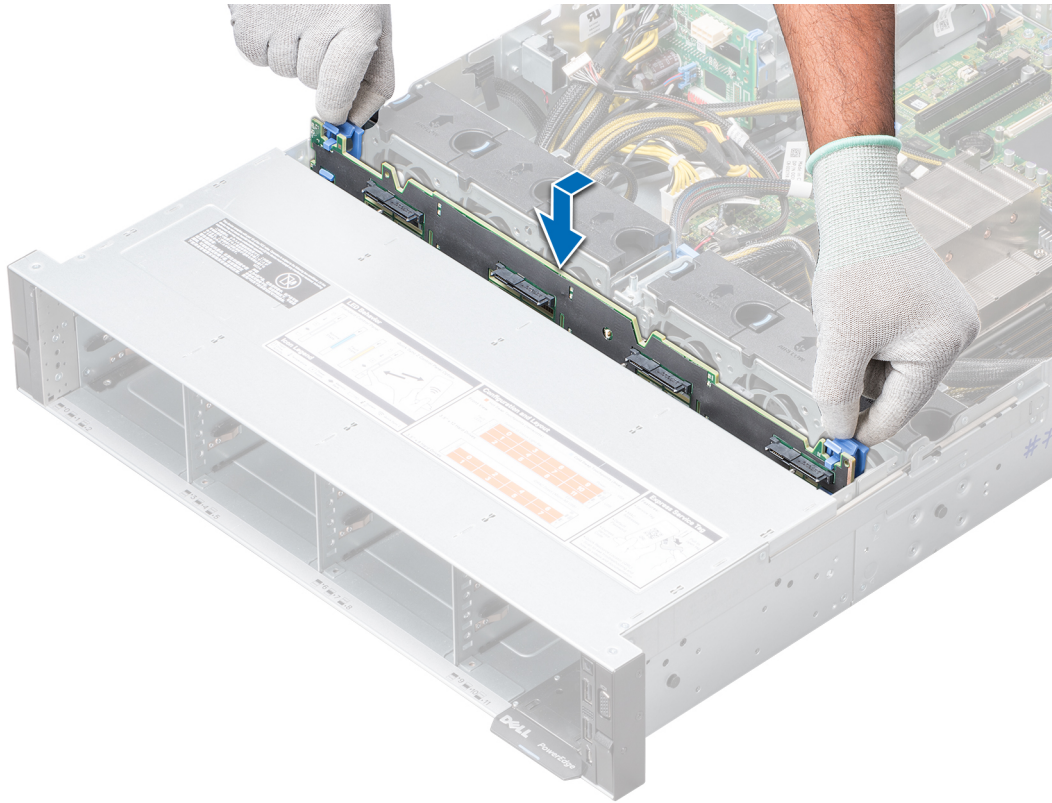
그림 65 . 드라이브 후면판 설치
