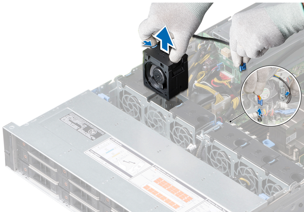
図 34. 冷却ファンの取り外し
