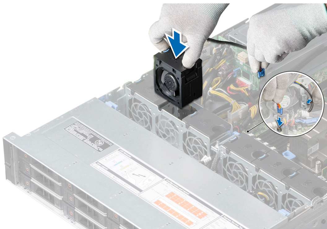
図 36. 冷却ファンの取り付け
