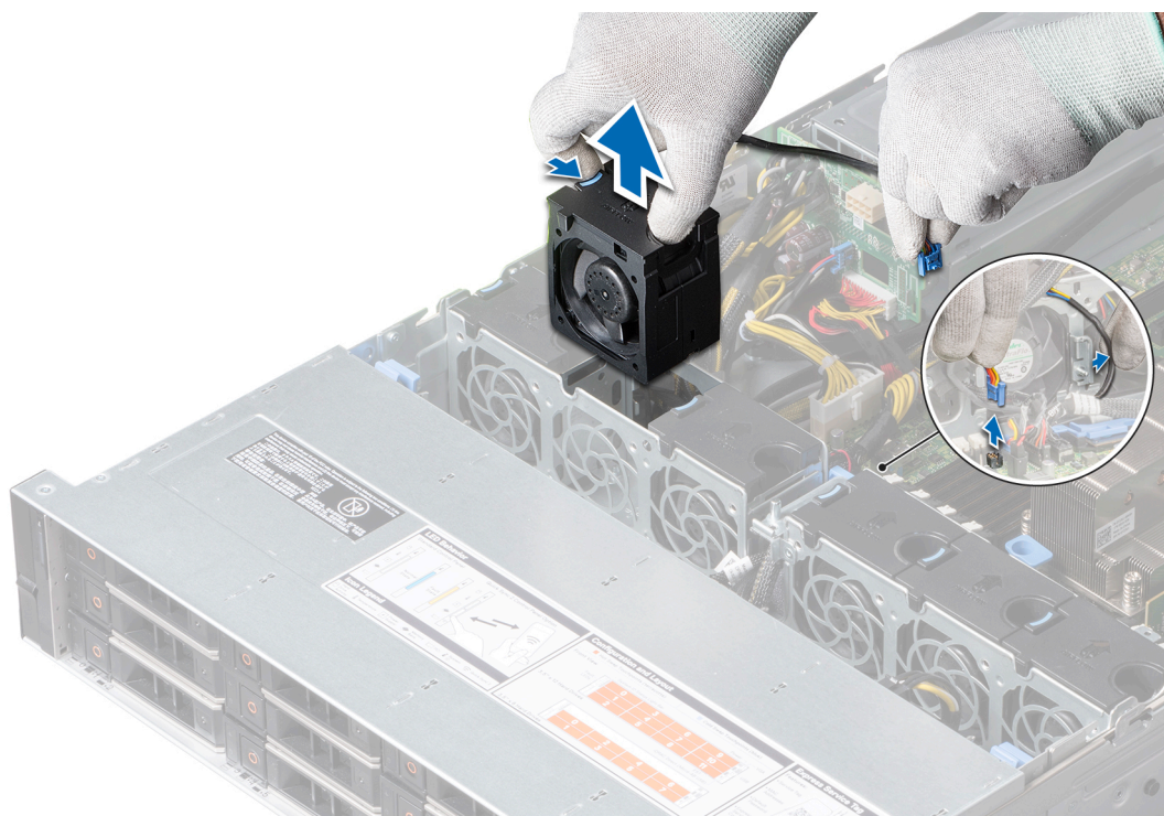
Figure 34. Retrait d'un ventilateur de refroidissement
