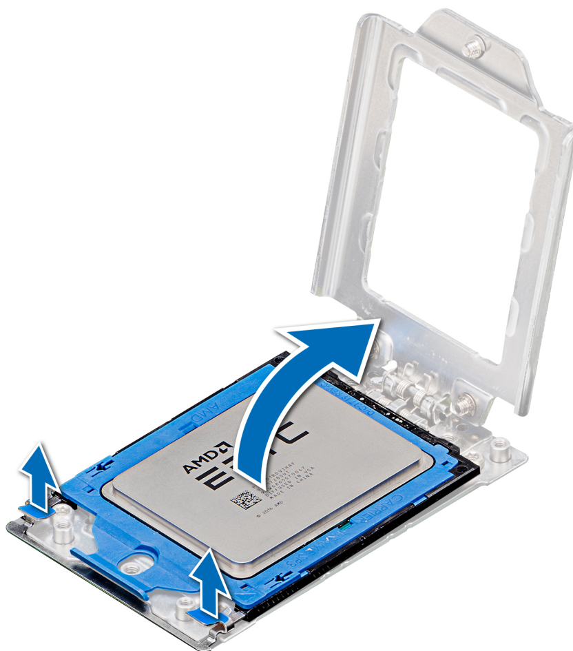
Figure 51. Soulèvement du cadre à glissière
