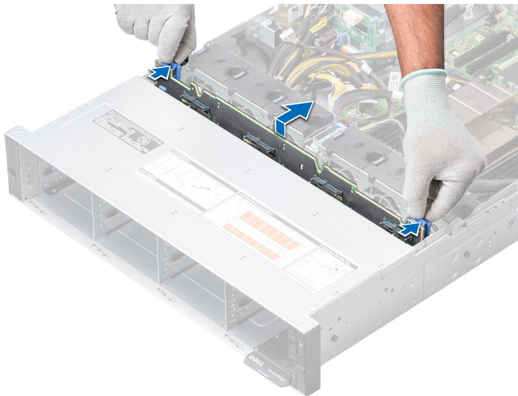
Figure 64. Retrait du fond de panier de disques
