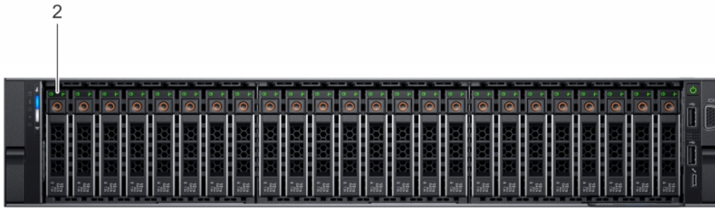
Figure 3. Vue avant du système à 24 disques de 2,5 pouces
