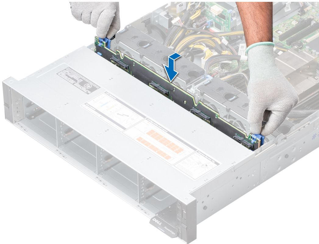
Figure 65. Installation du fond de panier de disques
