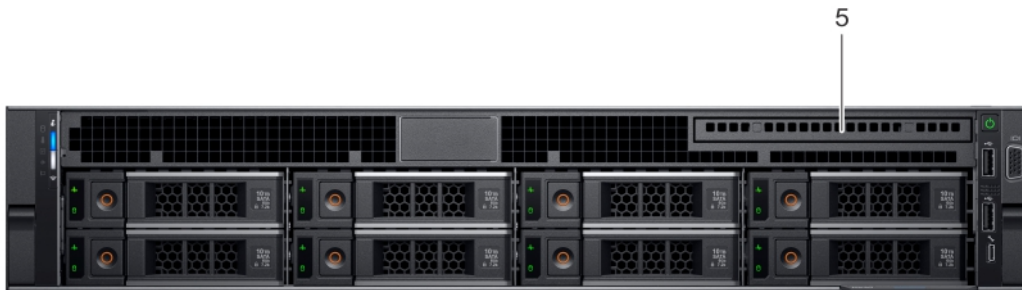
Figure 4. Vue avant du système à 8 disques de 3,5 pouces
