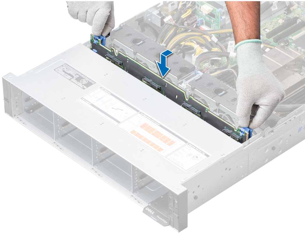
Ilustración 65. Instalación del plano posterior de la unidad de disco duro
