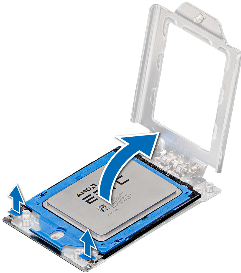
Ilustración 51. Levantamiento del marco del riel
