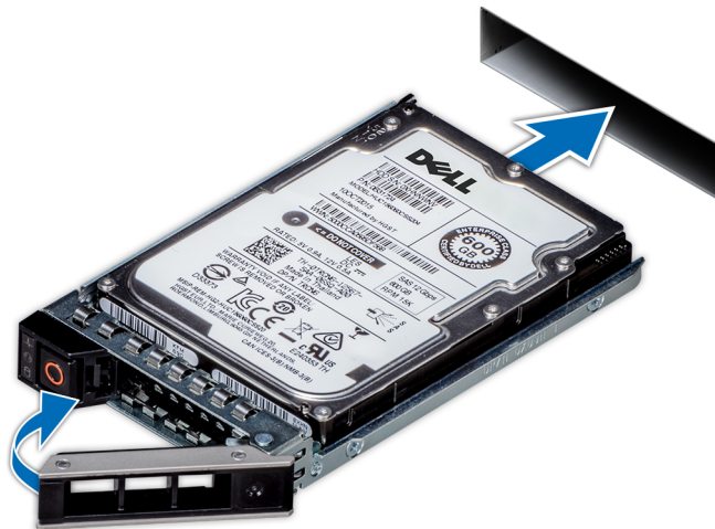
Ilustración 43. Instalación de una portadora de unidades
