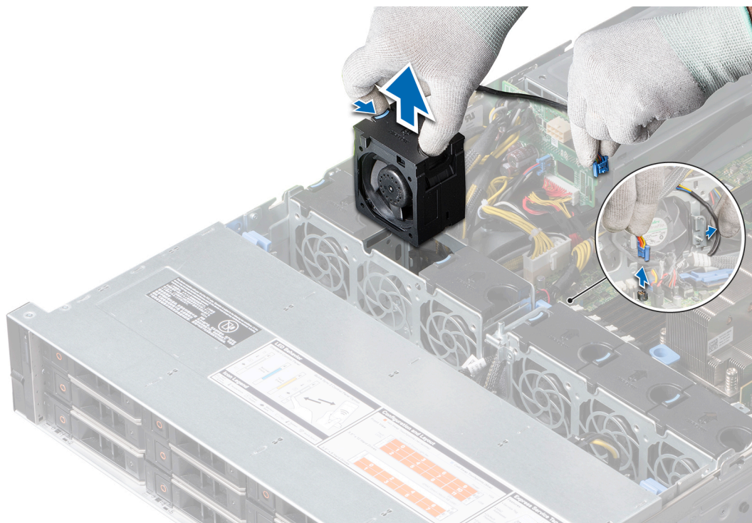
Ilustración 34. Extracción de un ventilador de refrigeración
