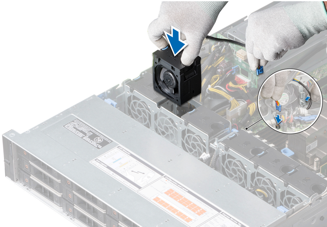
Ilustración 36. Instalación de un ventilador de refrigeración
