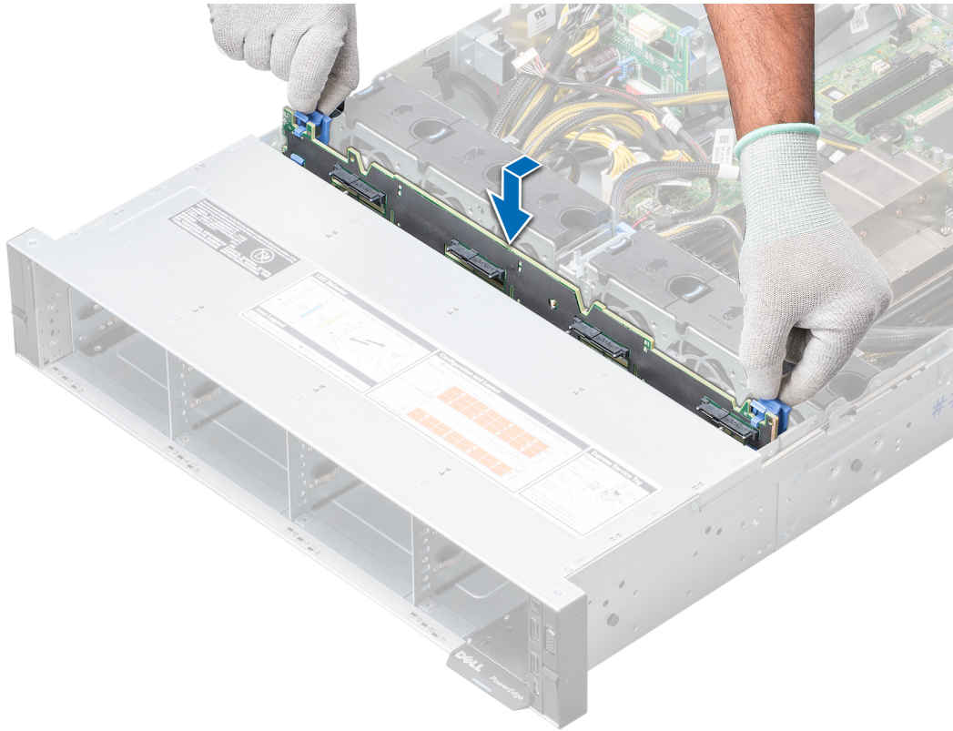
Abbildung 65. Installieren der Laufwerkrückwandplatine
