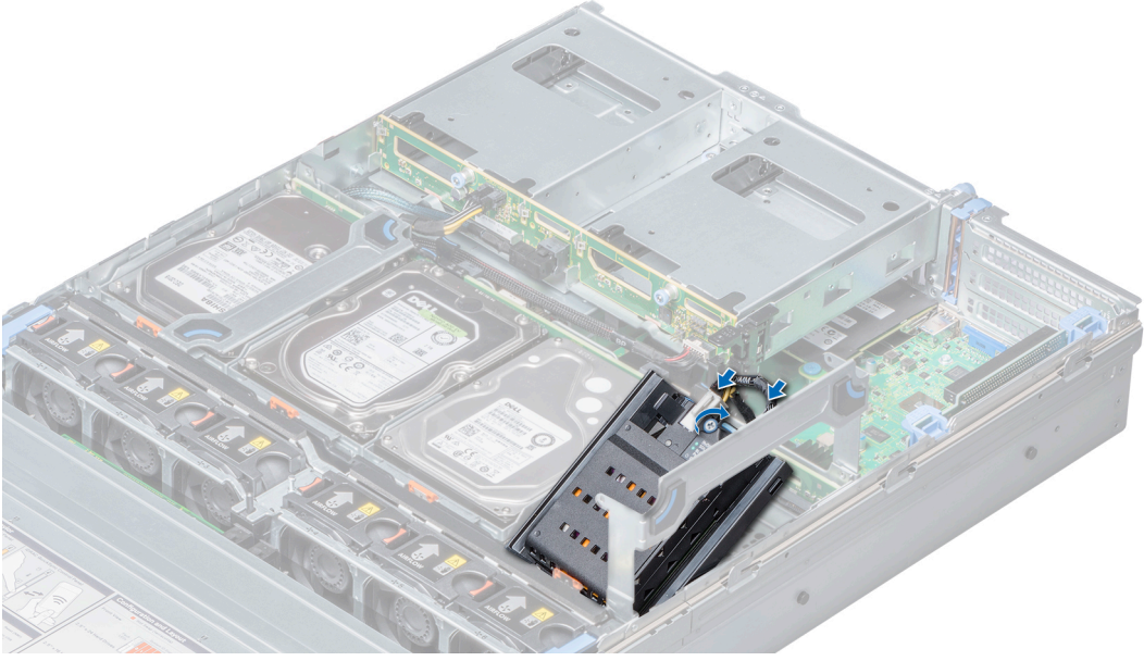
Rakam 42. NVDIMM-N pili orta sürücü tepsisine takma
