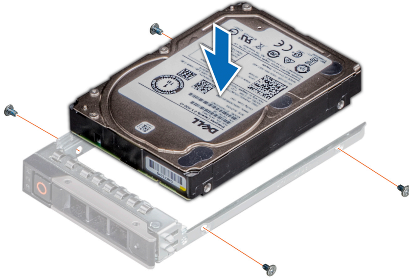
Rakam 64. Sürücü kutusuna sürücü takma
