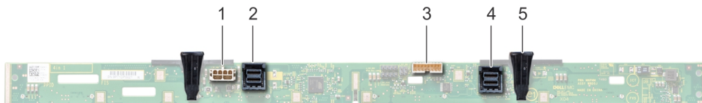
Figure 127. Vue arrière du fond de panier de 3,5 pouces (plateau de disque intermédiaire)
