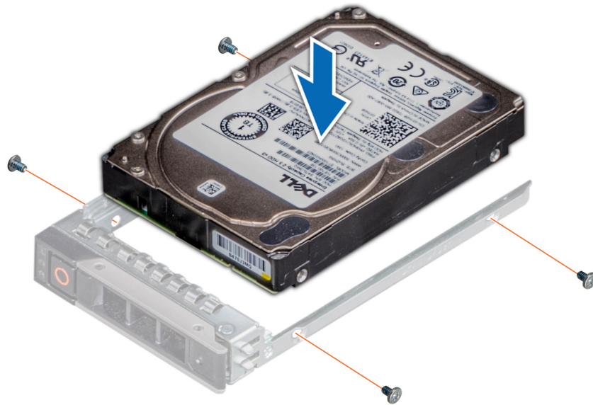
Figure 64. Installation d'un disque dans son support
