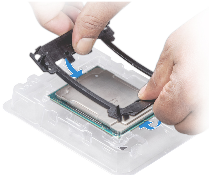
Figure 75. Installation du support de processeur
