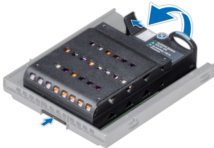
Figure 43. Retrait de la pile du NVDIMM-N du support
