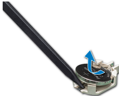
Ilustración 161. Extracción de la batería del sistema
