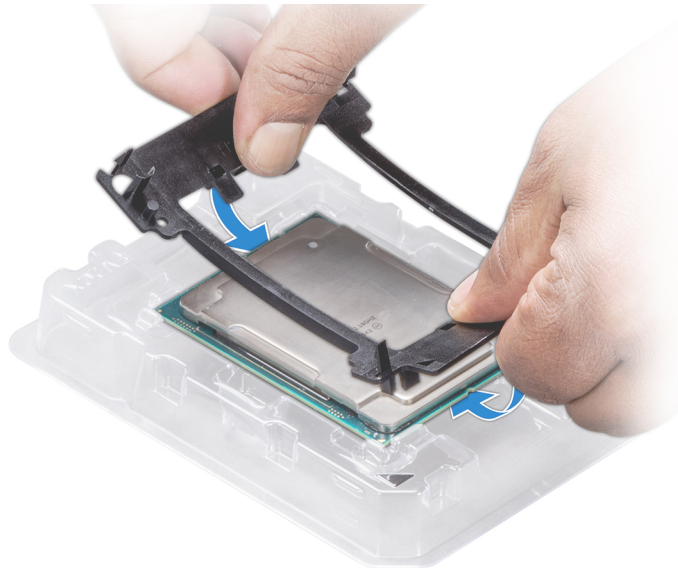
Ilustración 75. Instalación del soporte del procesador
