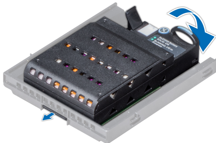
Ilustración 44. Instalación de la batería NVDIMM-N en el soporte
