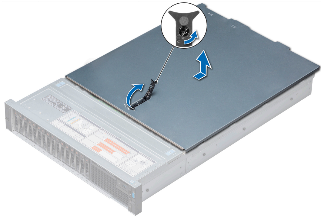
Ilustración 25. Extracción de la cubierta del sistema
