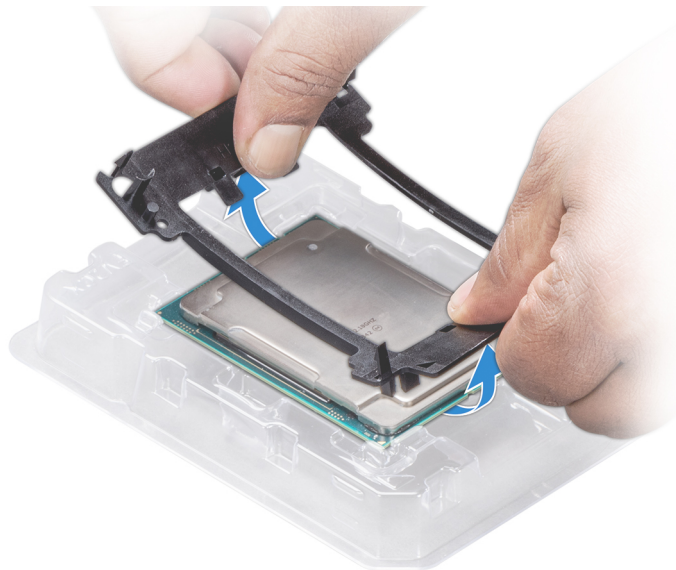
Ilustración 74. Extracción del soporte del procesador
