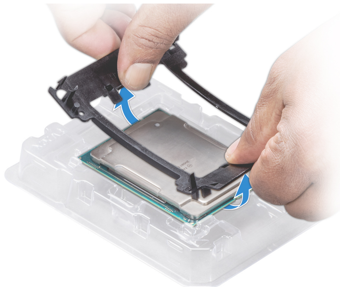
Abbildung 74. Entfernen der Prozessorhalterung
