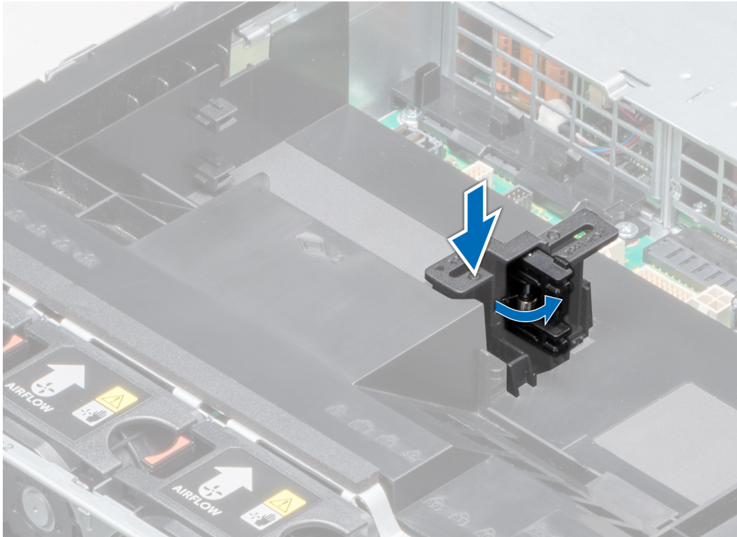
Abbildung 80. Öffnen des PCIe-Kartenhalterverriegelung
