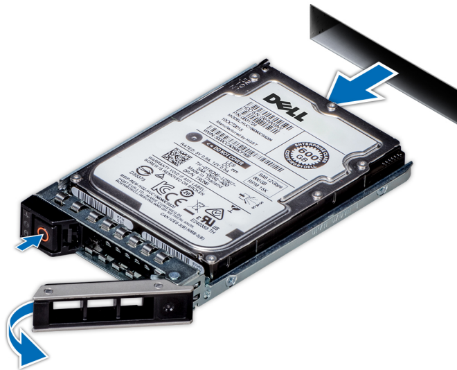
Abbildung 57. Entfernen eines Festplattenträgers
