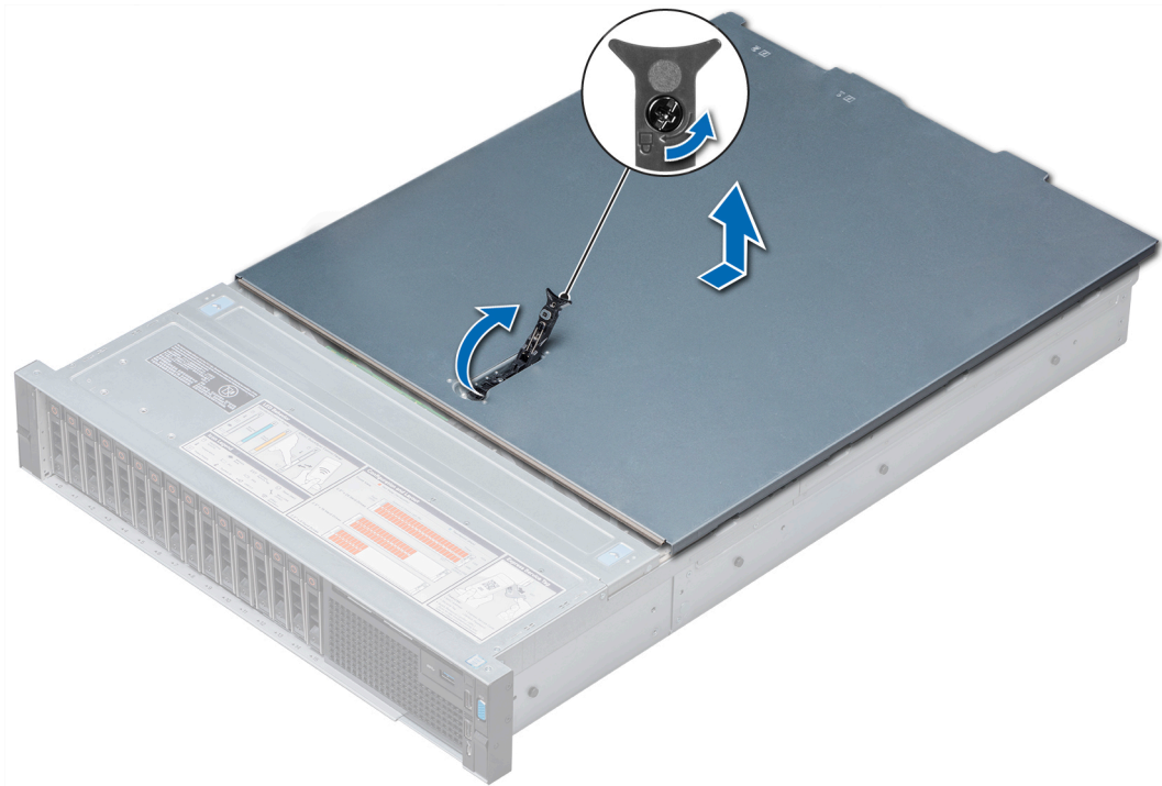
Abbildung 25. Entfernen der Systemabdeckung
