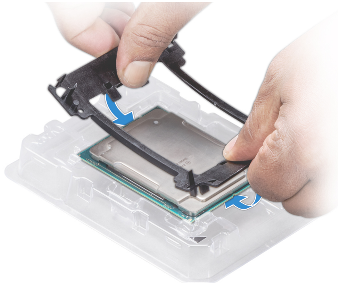
Abbildung 75. Installieren der Prozessor-Halterung
