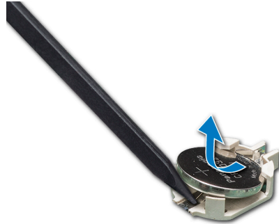
Abbildung 161. Entfernen der Systembatterie
