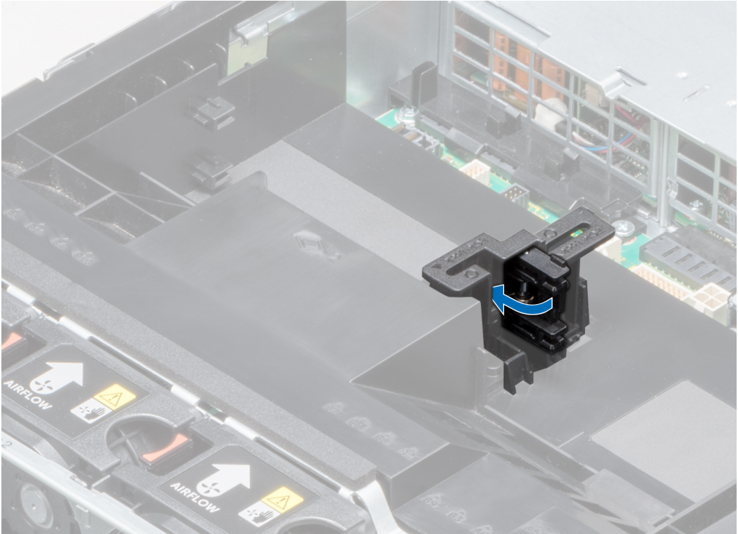
Rakam 65. PCIe kart tutucu mandalının kapatılması
