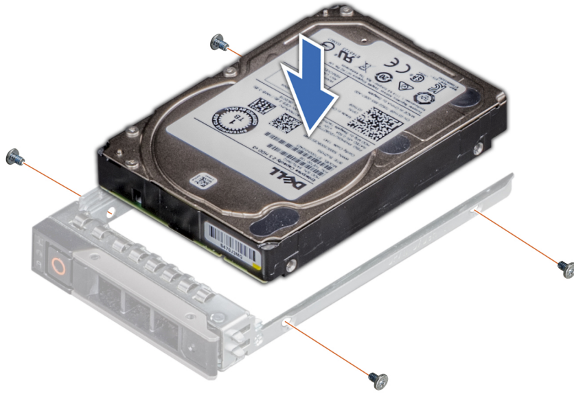
Rakam 54. Sürücü kutusuna sürücü takma
