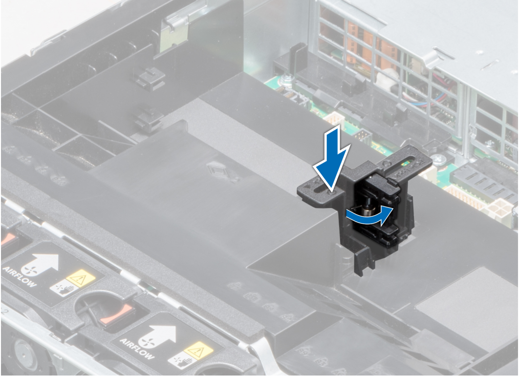
Rakam 64. PCIe kart tutucu mandalını açma
