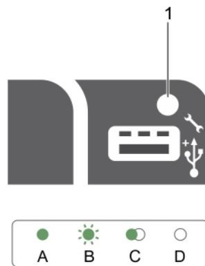
Ilustración 11. Códigos del indicador LED de iDRAC directo
