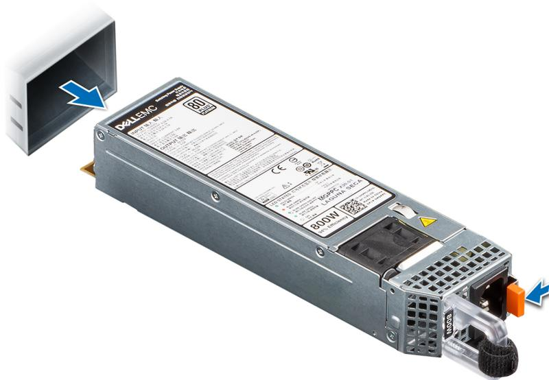
Abbildung 126. Netzteil entfernen
