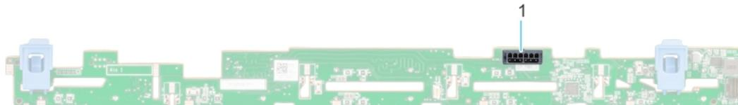
**Abbildung 40. 8 x 2,5-Zoll-Laufwerkrückwandplatine**
