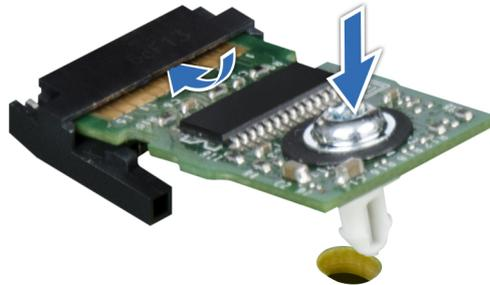
Abbildung 128. Installieren des TPM-Moduls
