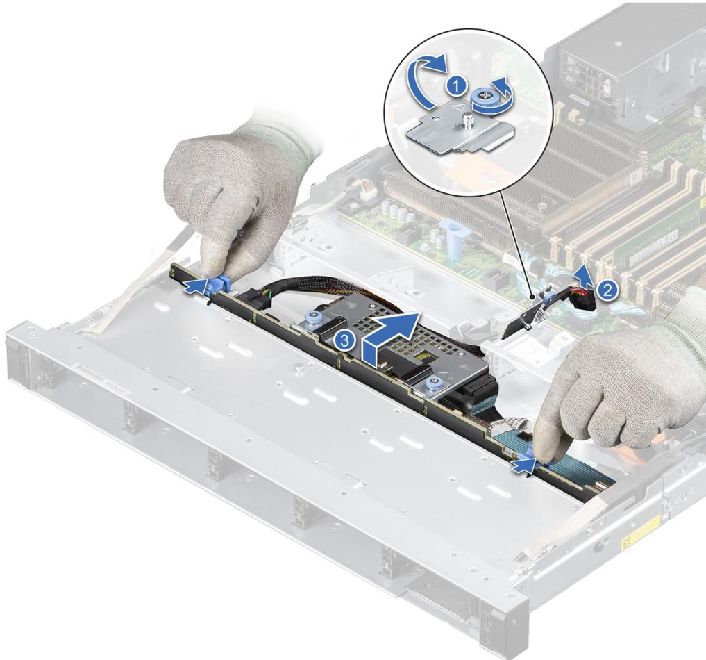
Abbildung 42. Laufwerkrückwandplatine entfernen
