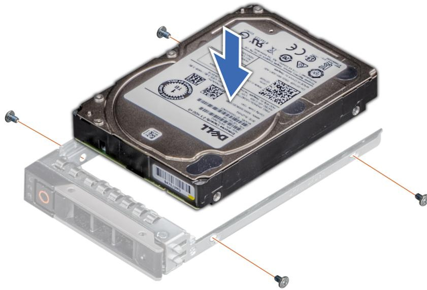
Abbildung 38. Einsetzen eines Laufwerks in den Laufwerksträger
