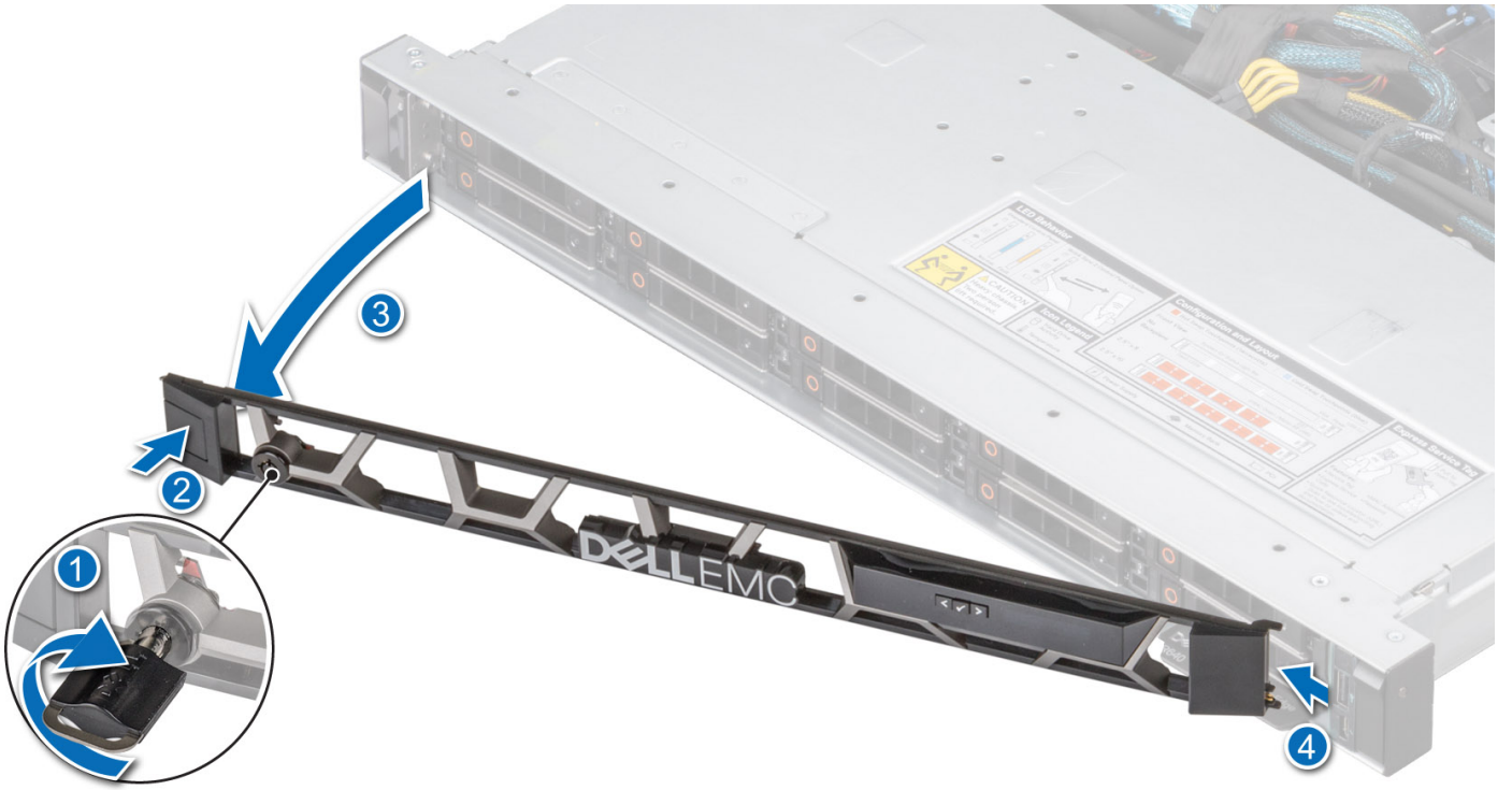
Rakam 12. LCD paneli ön çerçeveyi çıkarma
