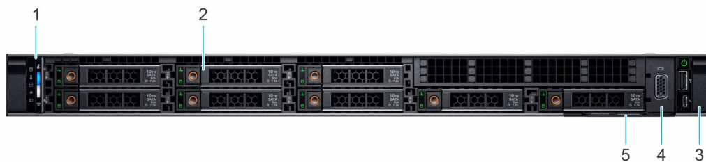
图 2: 8 x 2.5 英寸 SAS/SATA 驱动器系统的前视图
