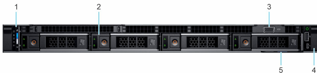
图 1: 4 x 3.5 英寸 SAS/SATA 驱动器系统的前视图
