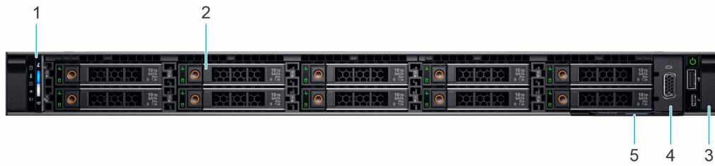
图 3: 10 x 2.5 英寸 SAS/SATA/NVMe 驱动器系统的前视图
