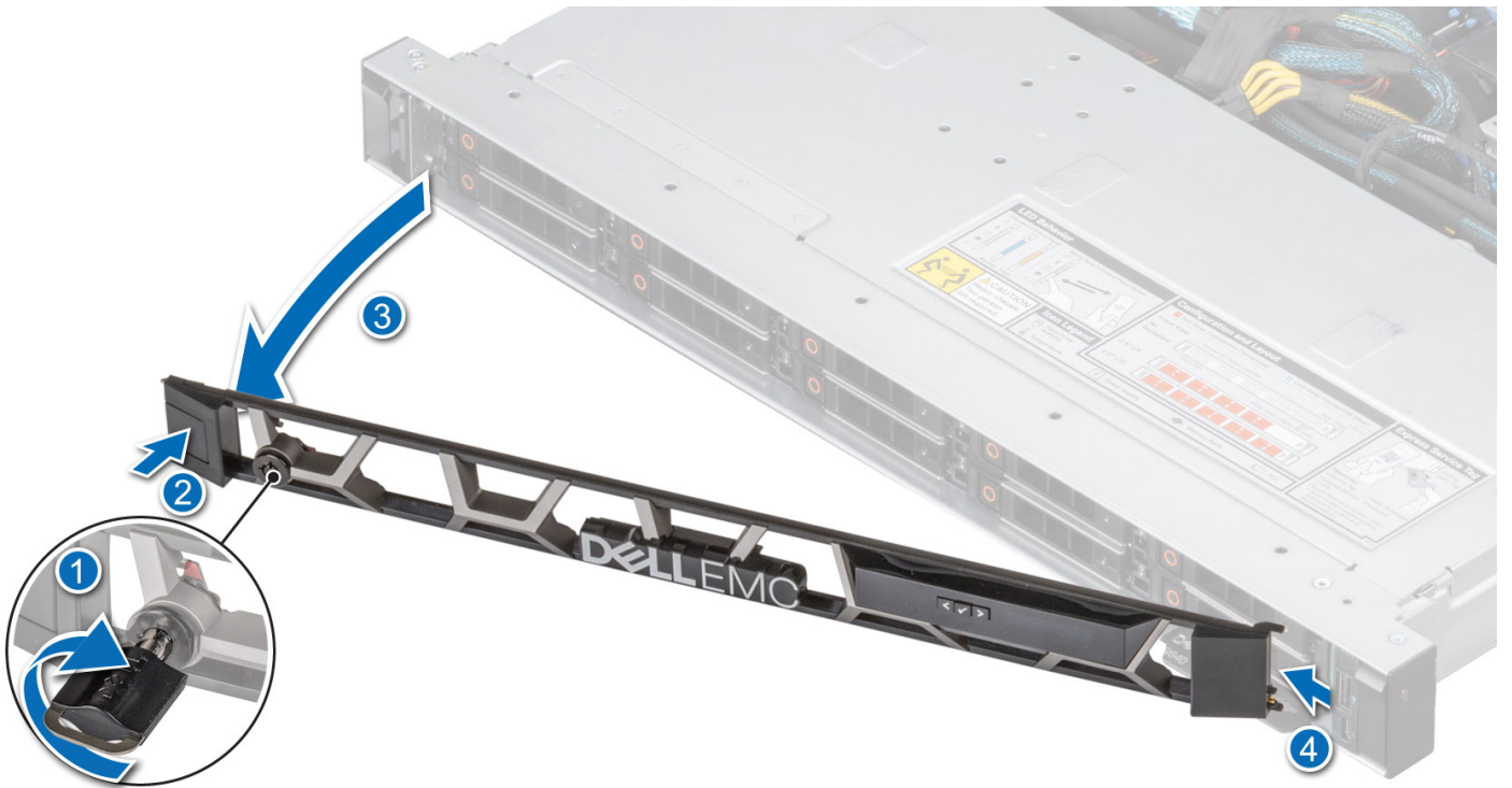
图 25: 卸下带 LCD 面板的前挡板
