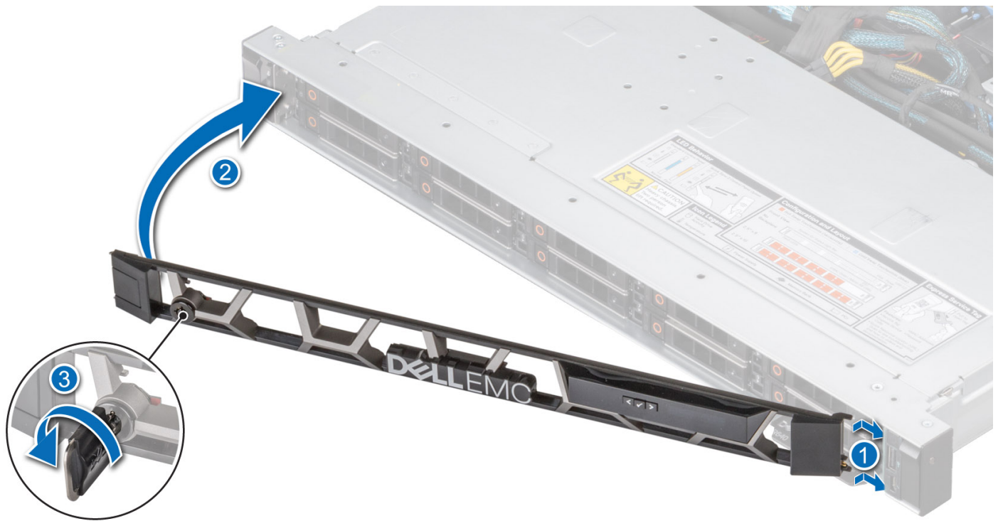
图 26: 安装带 LCD 面板的前挡板
