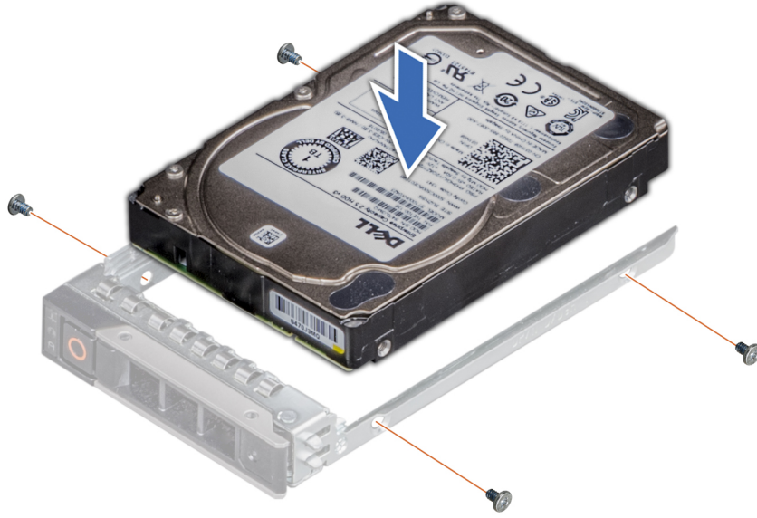
Rakam 42. Sürücü taşıyıcısına sürücü takma
