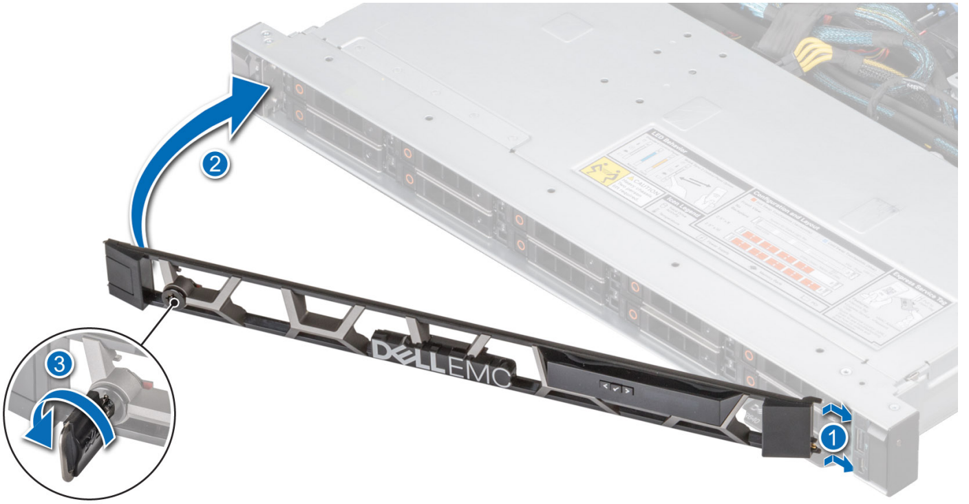
Rakam 26. LCD panelli ön çerçeveyi takma
