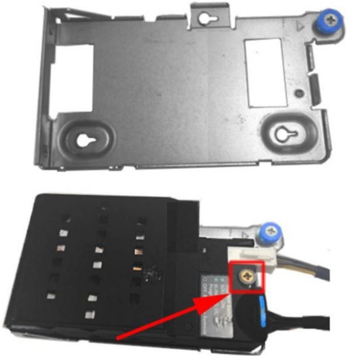
그림 151 . Installing battery on the battery tray
