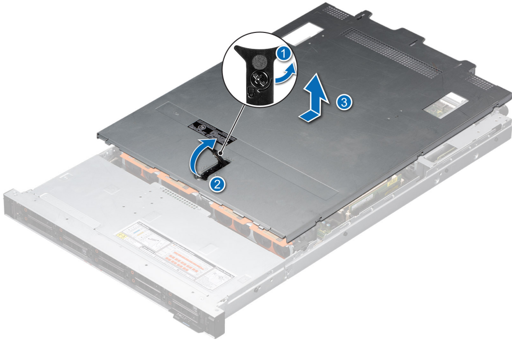
그림 27. 시스템 커버 제거
