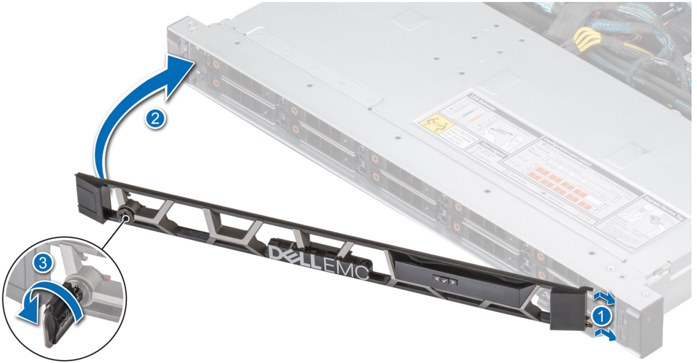
그림 26 . LCD 패널을 포함하는 전면 베젤 설치
