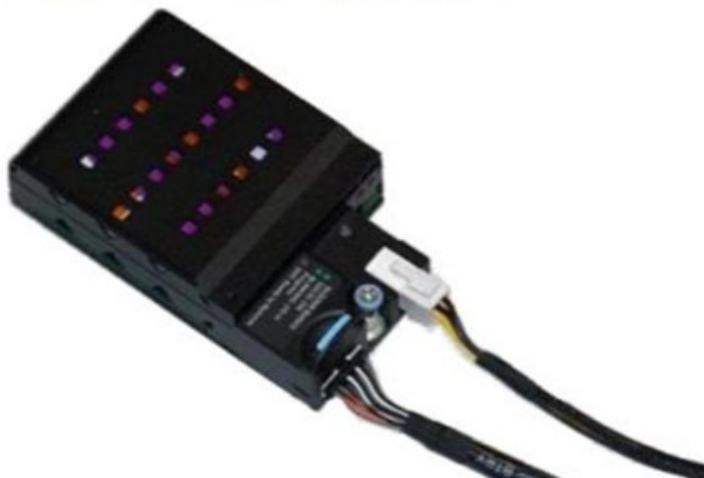
그림 150 . Connect power and signal cables to NVDIMM battery
