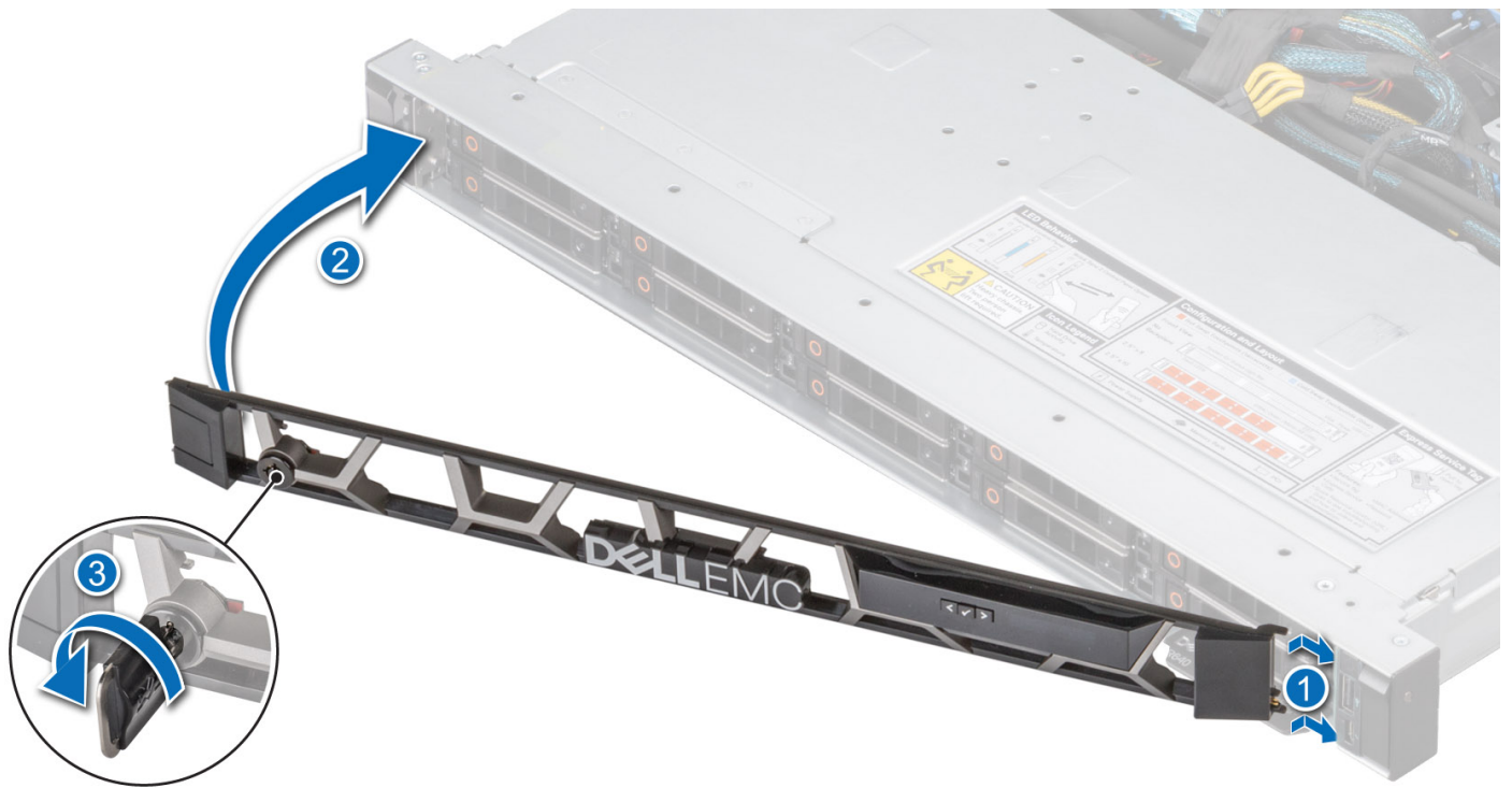
図 26. LCD パネルを持つ前面ベゼルの取り付け
