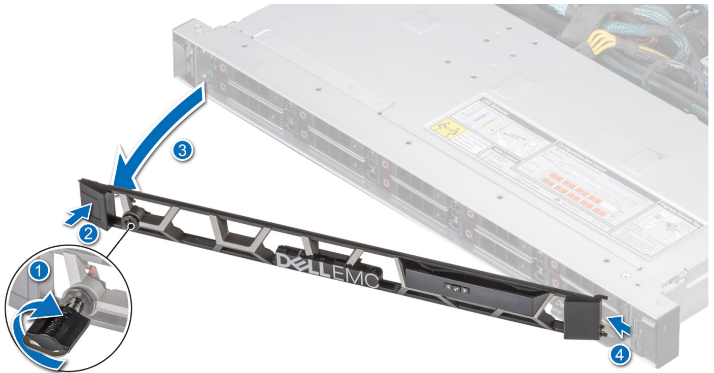
図 25. LCD パネルを持つ前面ベゼルの取り外し
