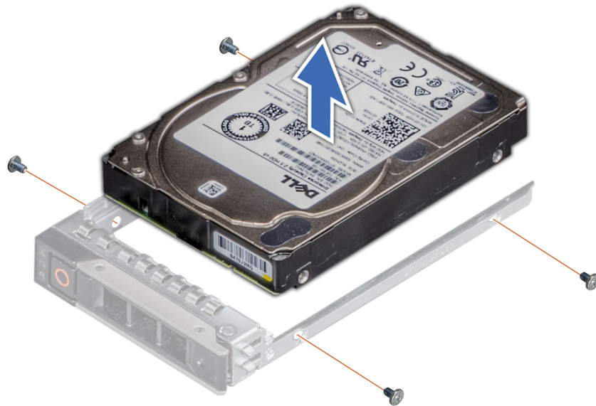
Figure 41. Retrait d'un disque dur installé de son support
