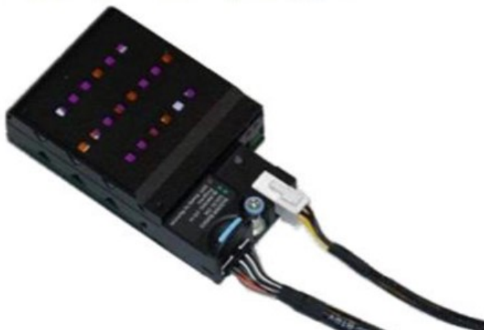
Figure 150. Branchement des câbles d'alimentation et de transmission à la batterie NVDIMM
