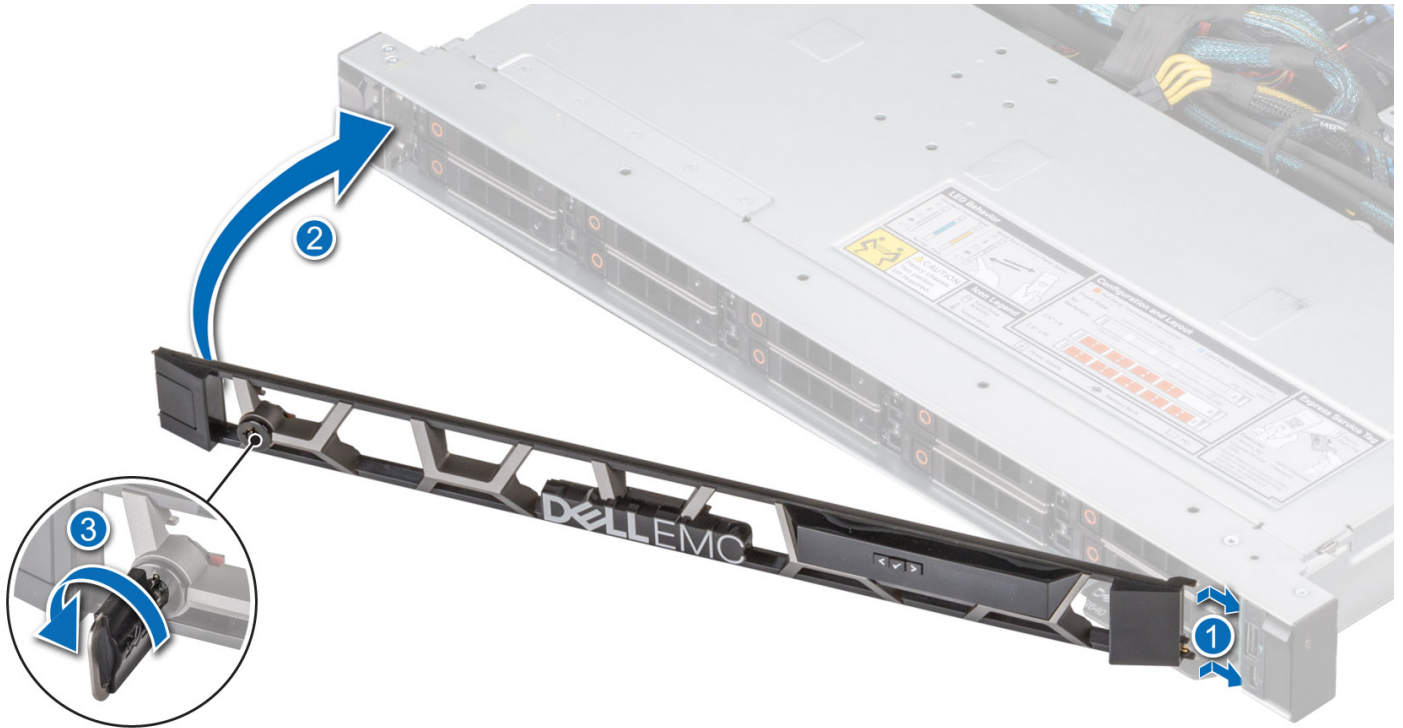
Figure 26. Installation du panneau avant avec l'écran LCD
