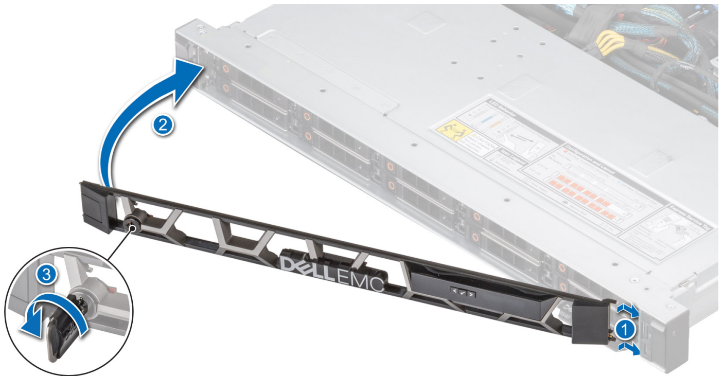
Ilustración 26. Instalación del bisel frontal con el panel LCD
