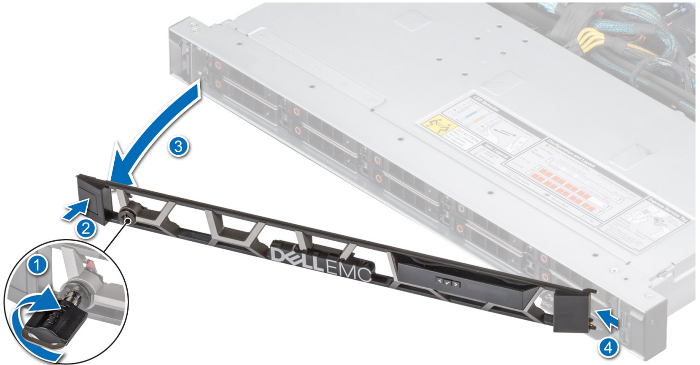
Ilustración 25. Extracción del bisel frontal con el panel LCD
