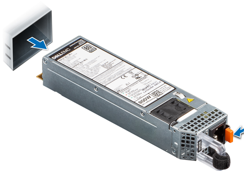
Ilustración 132. Extracción de una fuente de alimentación
