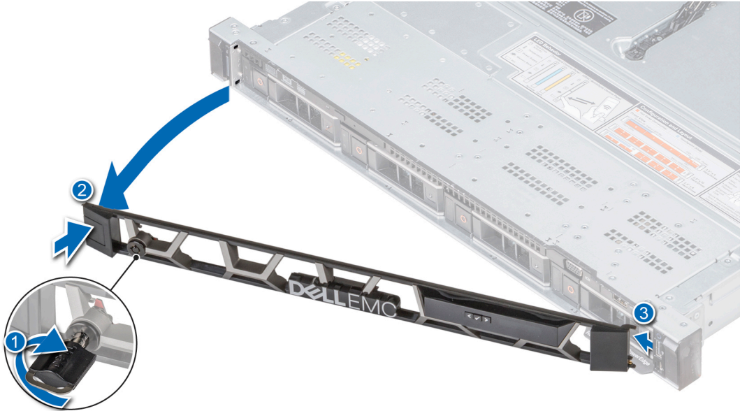
Rakam 22. Ön çerçeveyi LCD panelle birlikte çıkarma
