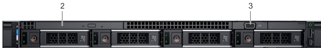
Rakam 2. 8 x 2,5 inç sürücü sisteminin önden görünümü
