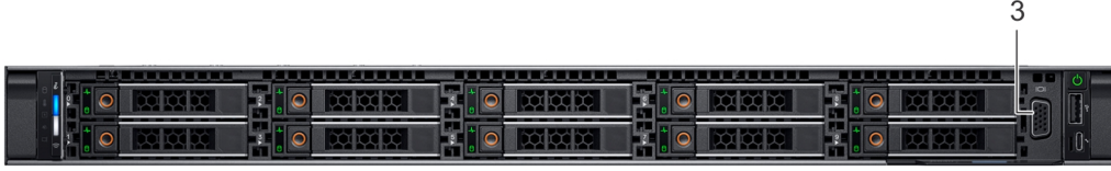
Rakam 4. 10 x 2,5 inç sürücü sisteminin önden görünümü
