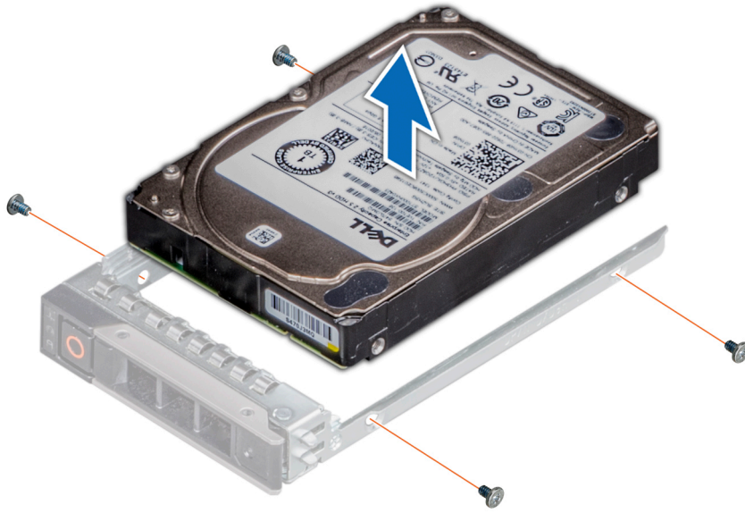
Rakam 39. Sürücüyü sürücü taşıyıcısından çıkarma
