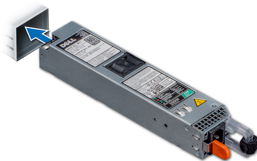
그림 86. 핫 스왑 가능한 PSU 설치
