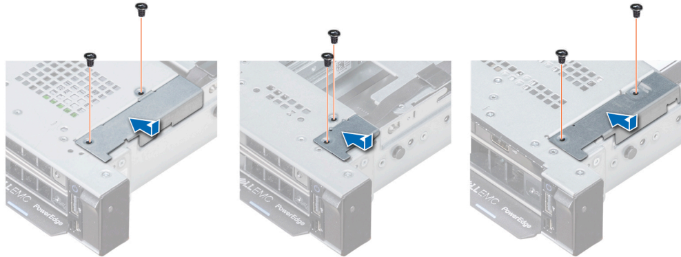
그림 96 . 케이블 덮개 설치
