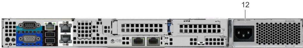
그림 13. 케이블 연결된 PSU가 있는 시스템의 후면 모습
