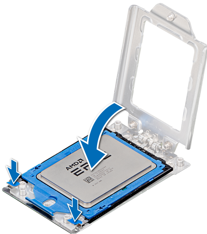
図 49. プロセッサソケットフレームを閉じる
