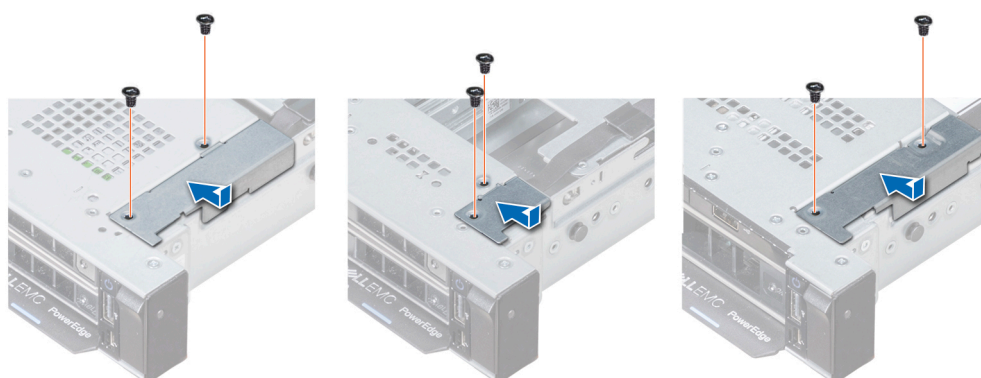
図 96. ケーブルカバーの取り付け
