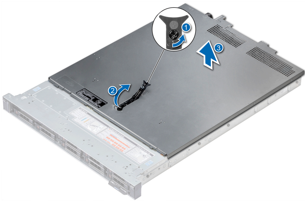
図 24. システムカバーの取り外し
