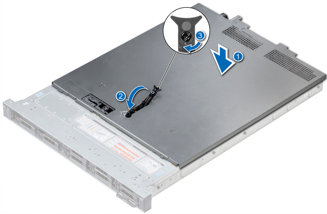
図 25. システムカバーの取り付け
