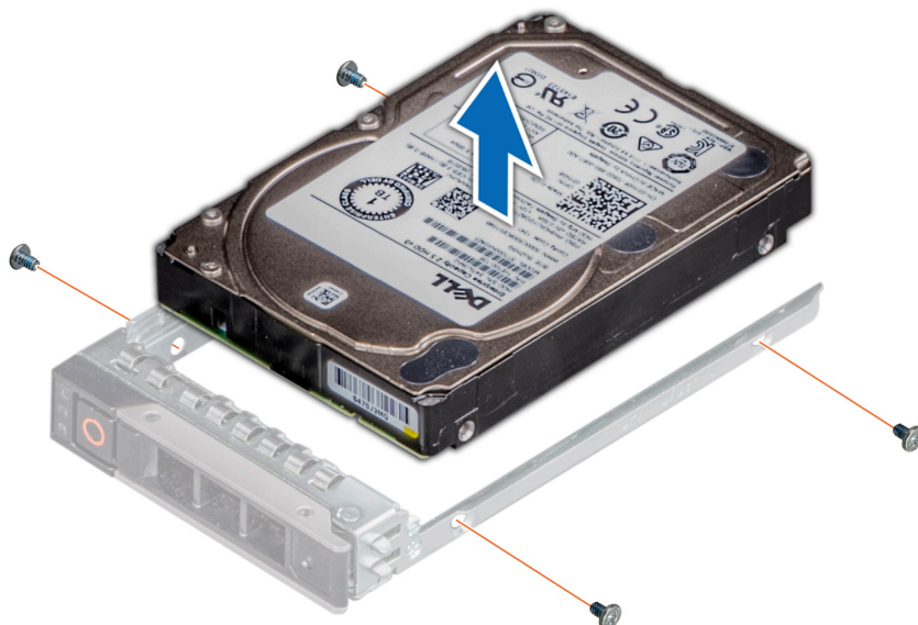
図 39. ドライブキャリアからのドライブの取り外し
