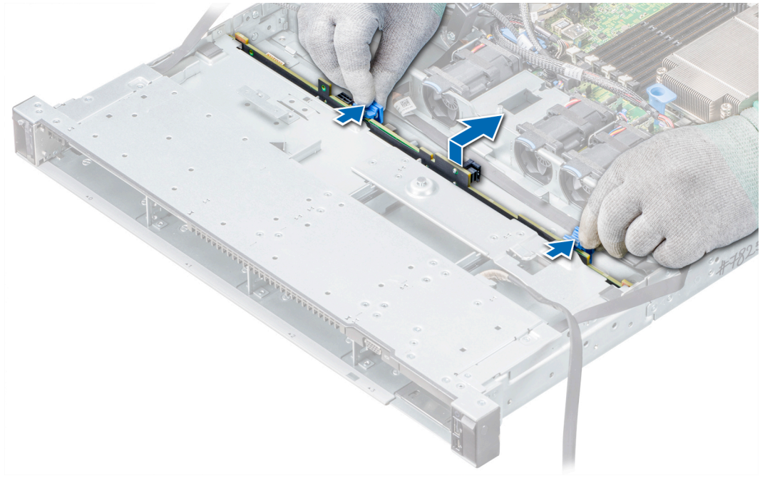
図 73. バックプレーンの取り外し
